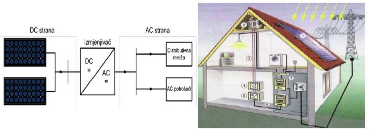
Slika 1. Fotonaponski sustav spojen na mrežu [7]
