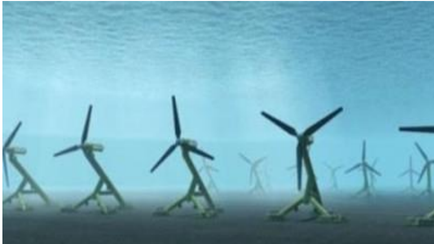
Slika 6. Podvodne turbine za crpljenje energije plime i oseke [14]
