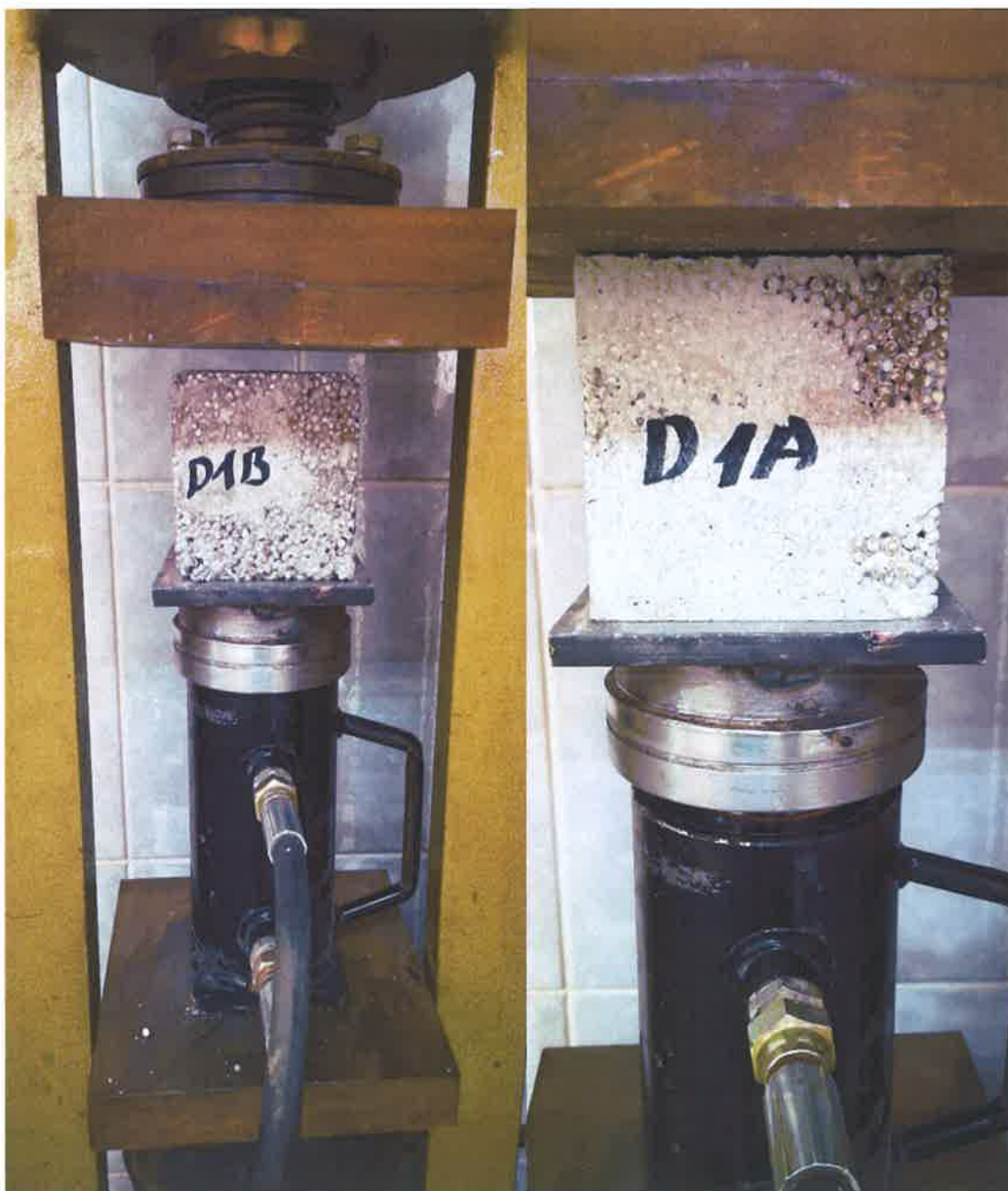
Slika 8 (a) Uzorak u uređaju za ispitivanje tlačne čvrstoće (b) Detaljniji prikaz
