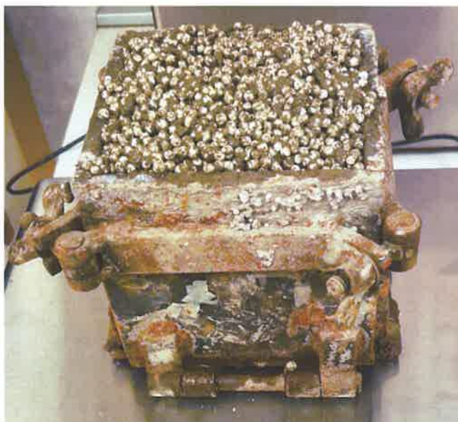
Slika 6 Kalup zapunjen lakim betonom
