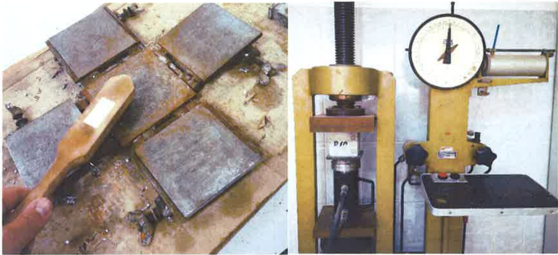
Slika 3 (a) Metalni kalup (b) Uređaj za mjerenje tlačne čvrstoće
