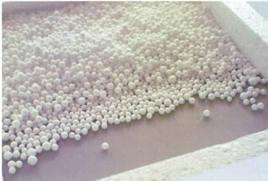
Slika 2 EPS u granulama ( Kemenović, n.d. )
