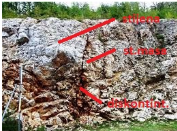
Slika 1. Stijenska masa, stijena i diskontinuiteti (GFV.hr)
