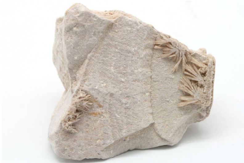
Slika 7. Slabo vezana stijena – mineral gline kaolinit (RGN.hr)
