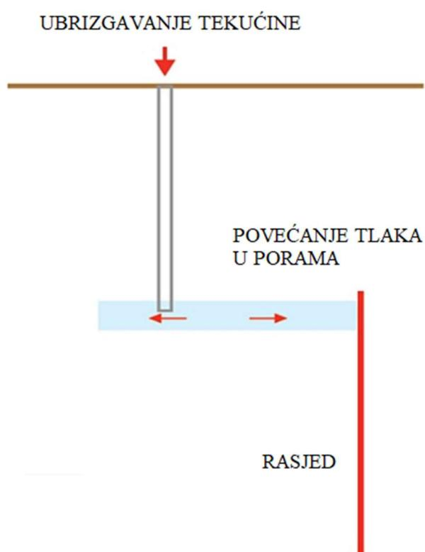
Slika 14 Povećanje tlaka u tlu ubrizgavanjem tekućina
