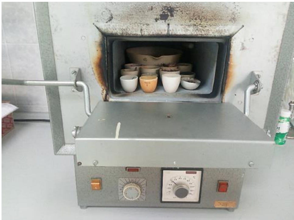
Slika 3.5.: Uzorak u peći za žarenje
