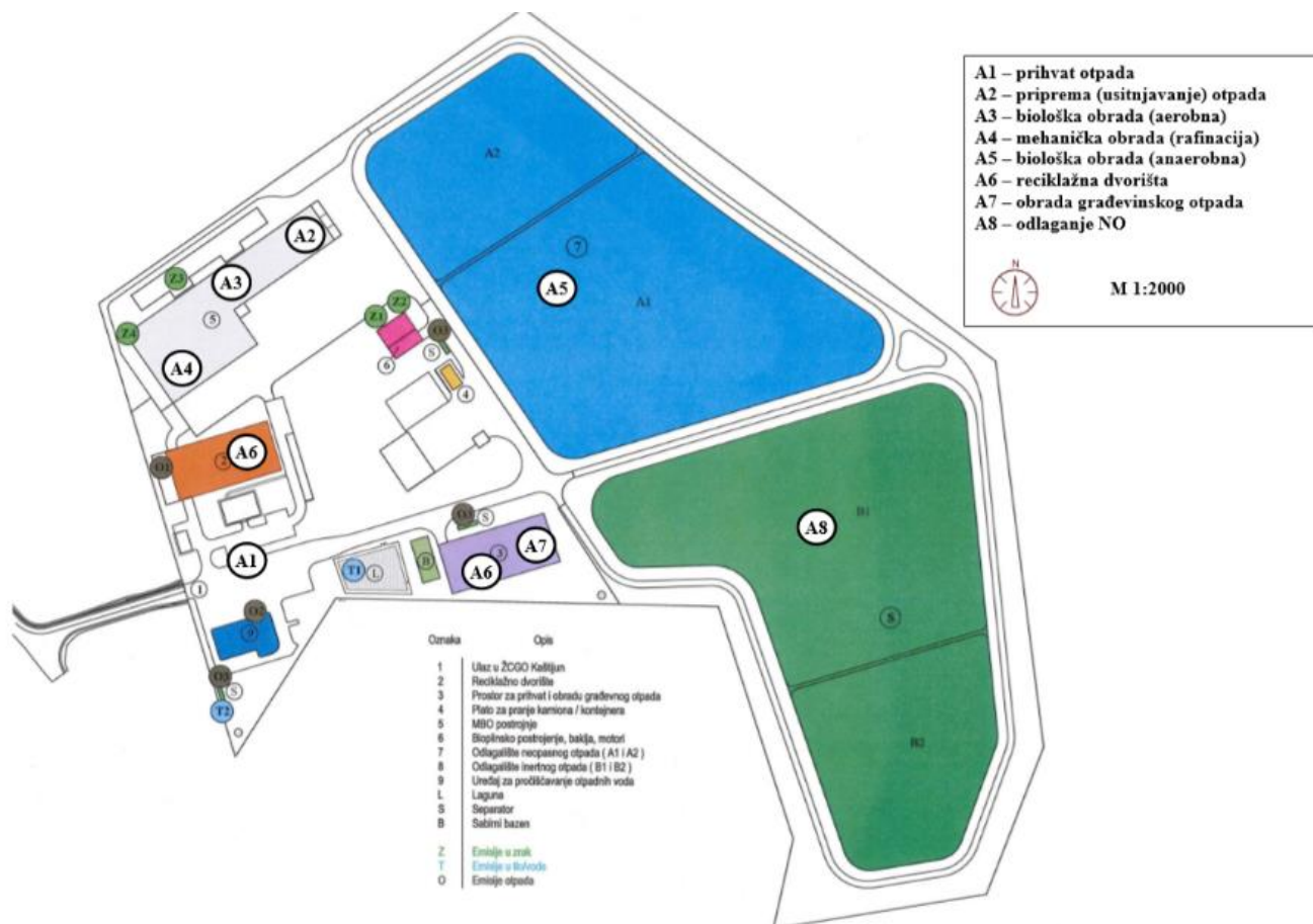
Slika 2.2. Nacrt prostornog razmještaja tehnoloških procesa [4]
