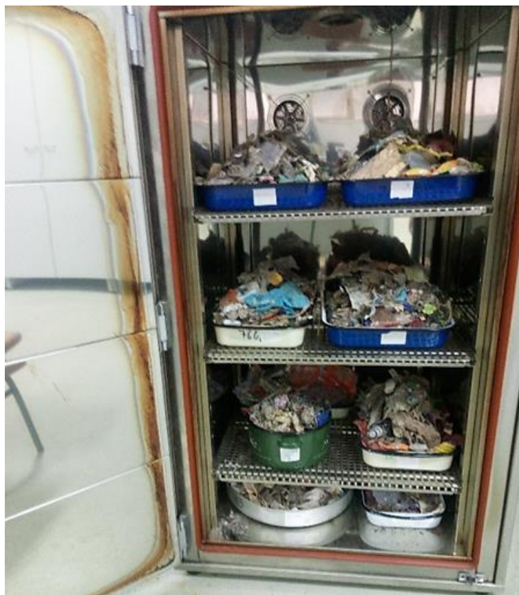
Slika 3.2.: Uzorci sitne frakcije komunalnog otpada iz ŽCGO Kaštijun u sušioniku
