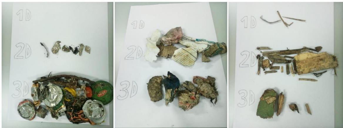
Slika 3.6.: Komponente uzorka iz ŽCGO Kaštjun razdvojene prema obliku (s lijeva na desno: metali, papir i karton, drvo)
