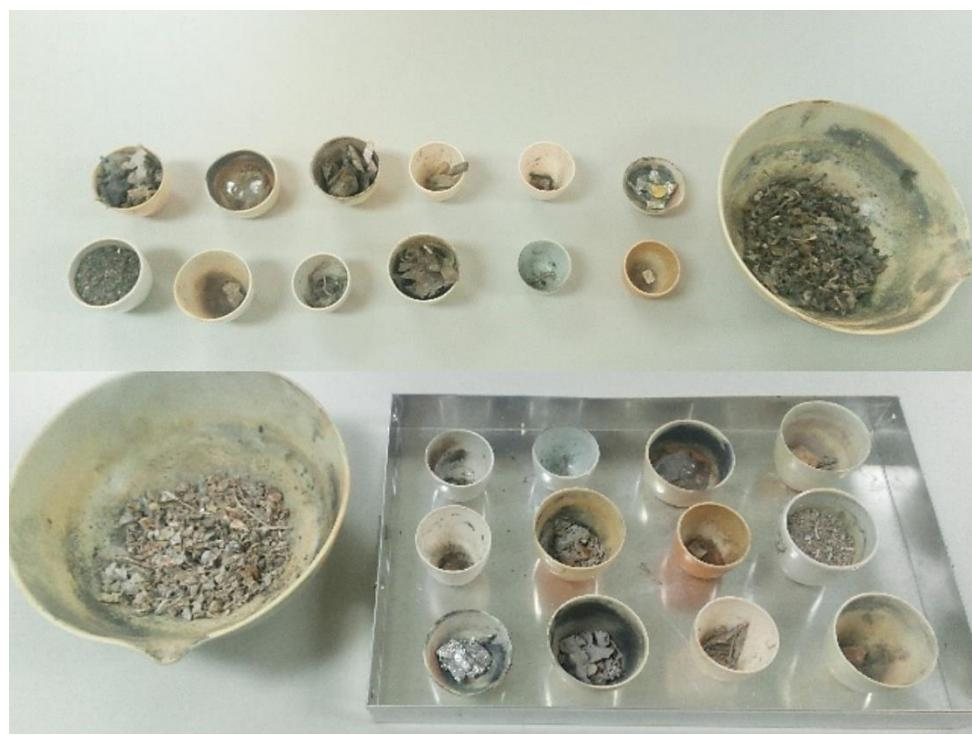
Slika 3.4.: Komponente reprezentativnog uzorka prije i nakon žarenja
