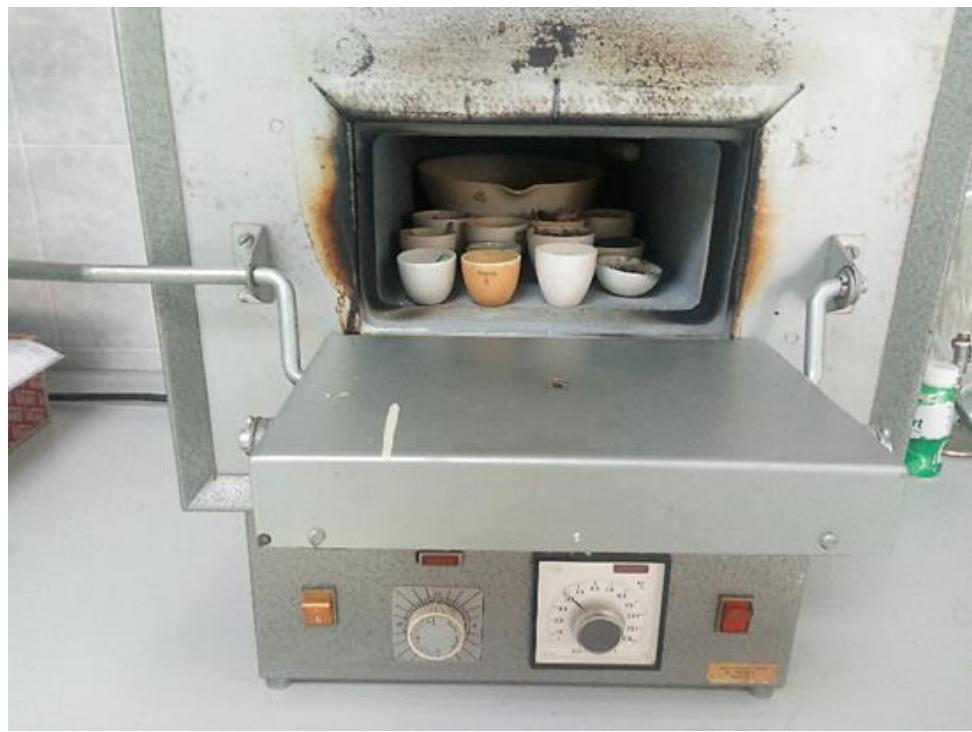
Slika 3.5.: Uzorak u peći za žarenje
