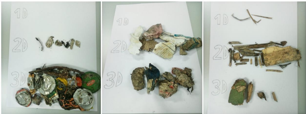
Slika 3.6.: Komponente uzorka iz ŽCGO Kaštijun razdvojene prema obliku (s lijeva na desno: metali, papir i karton, drvo)
