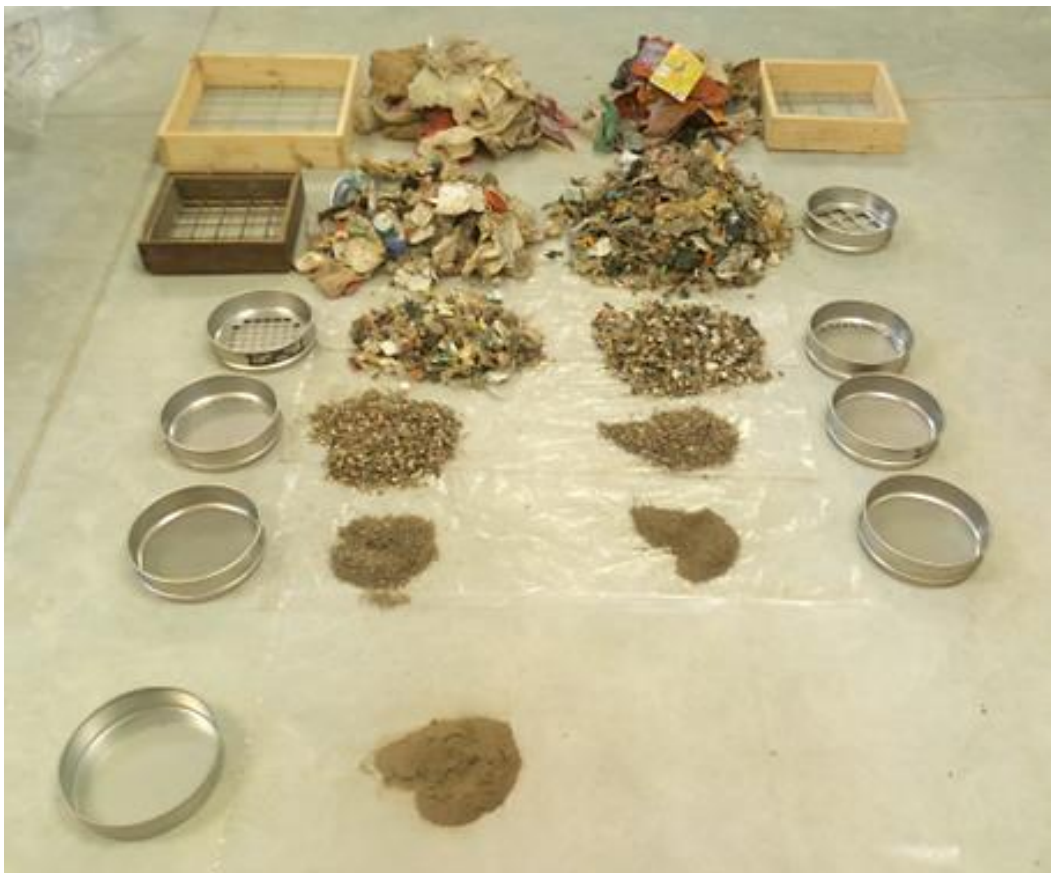
Slika 3.7.: Sita i prosijani uzorak iz ŽCGO Kaštijun
