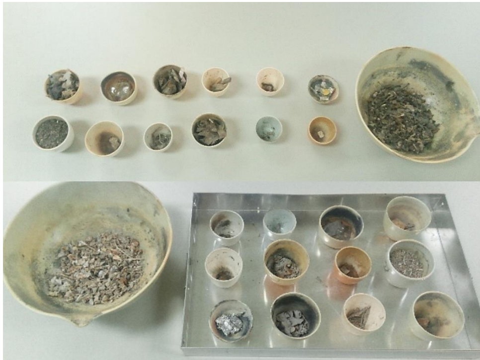
Slika 3.4.: Komponente reprezentativnog uzorka prije i nakon žarenja
