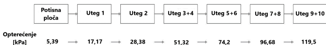
Slika 21. Postupak opterećenja uzorka
