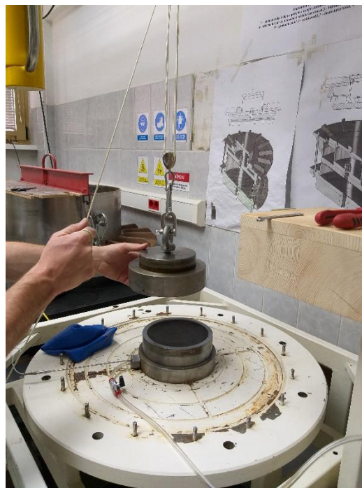
Slika 20. Postavljanje potisne ploče
