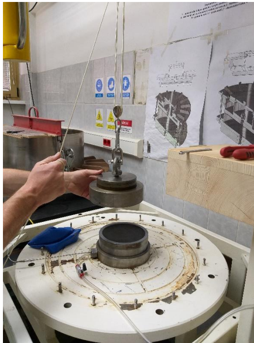
Slika 20. Postavljanje potisne ploče
