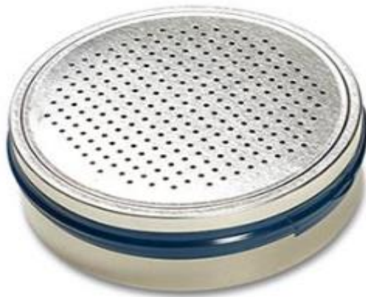
Slika 11. Prikaz kanistra s aktivnim ugljenom za detekciju radona [25]
