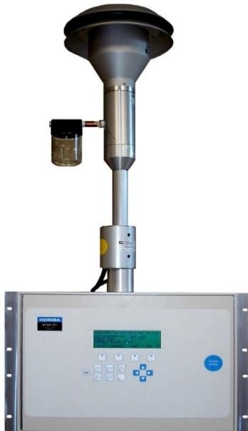
Slika 18. Prikaz mjernog uređaja Horiba model APDA 371
