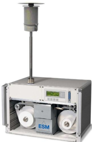
Slika 17. Prikaz mjernog uređaja Thermo Andersen ESM FH 62 I-R
