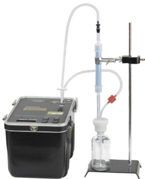
Slika 10. Uređaj RAD7 s dodacima za mjerjenje radona u vodi [14]
