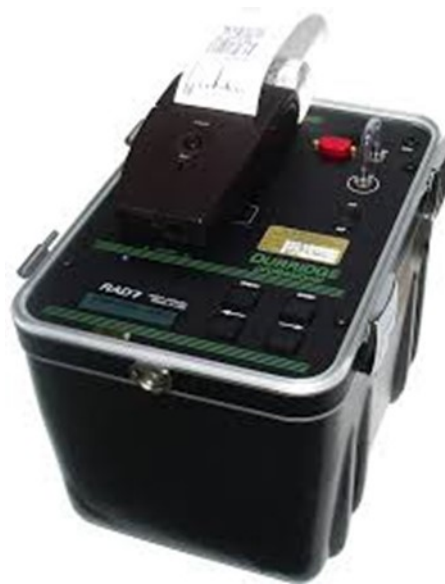
Slika 9. Alfa spektrometar DURRIDGE RAD7 [13]
