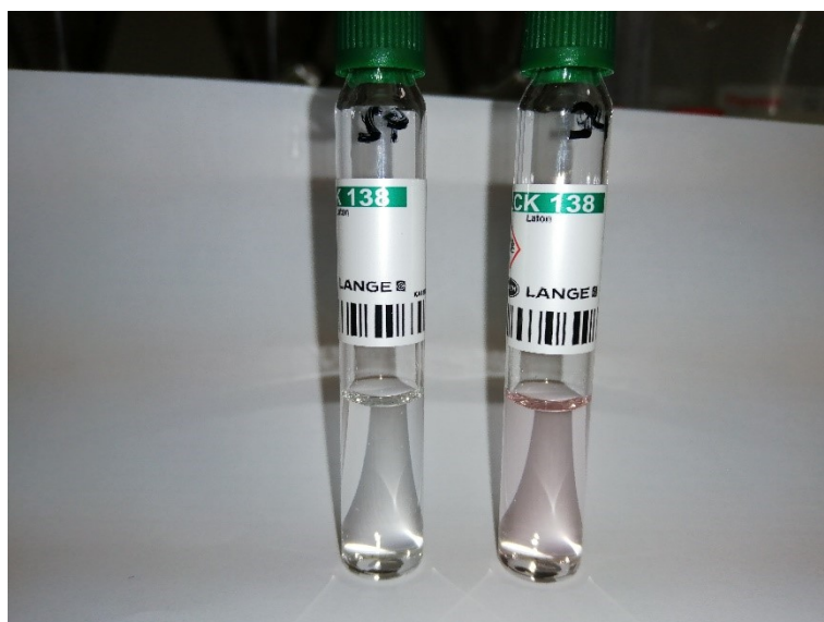
Slika 10. Slijepa proba (lijevo) i uzorak površinske vode koji je zbog prisustva dušika blago ružičaste boje (desno)
