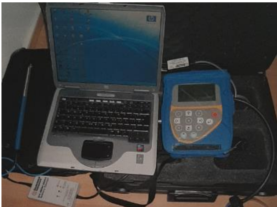
Slika 6. Instrument za mjerenje plinova – GA 2000 – ANSYCO [16]
