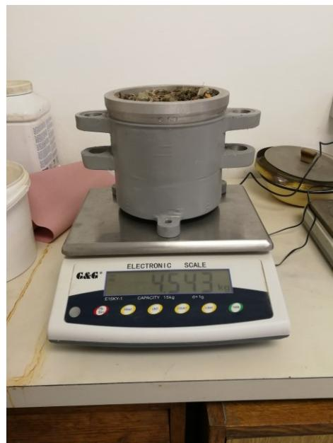
Slika 17. Vaganje kalupa sa uzorkom
