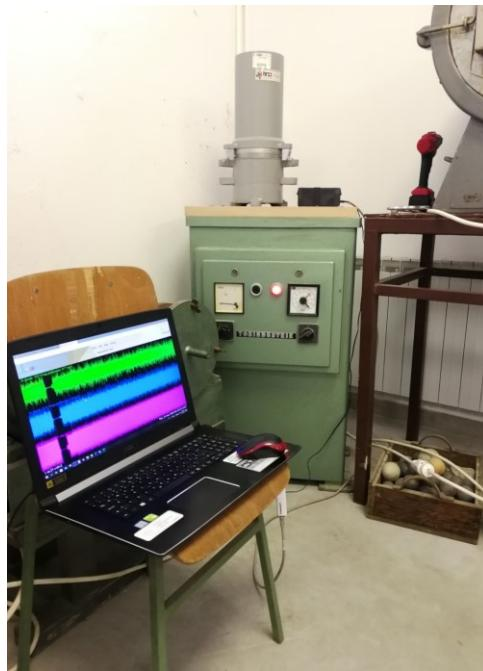
Slika 9. Utvrđivanje frekvencije titranja vibro ploče
