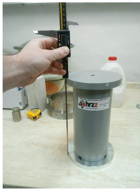
Slika 11. Određivanje visine cilindra iznad kalupa
