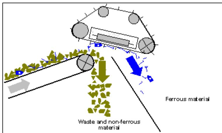
Slika 7. Odvajanje magnetičnih metala od otpada [9]
