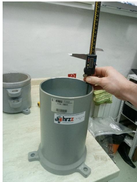
Slika 12. Određivanje visine cilindra iznad kalupa
