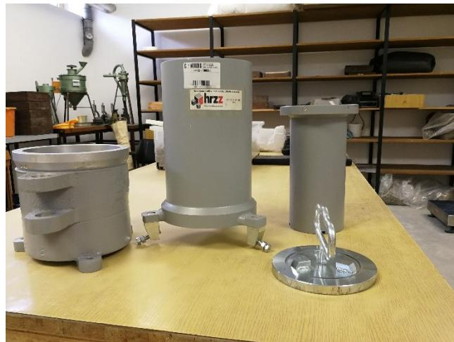
Slika 10. Kalup za određivanje zbijenosti vibro pločom
