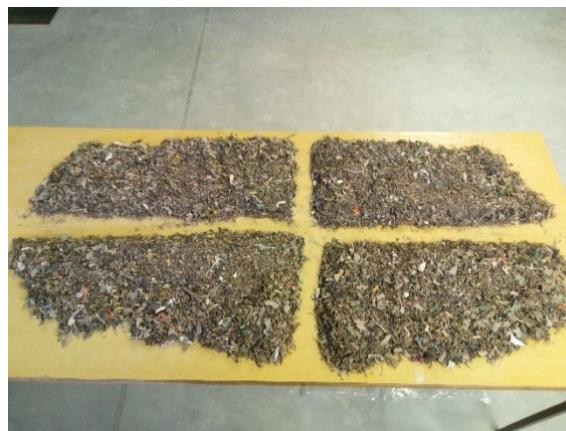
Slika 14. Odabir reprezentativnog uzorka, metodom četvrtanja
