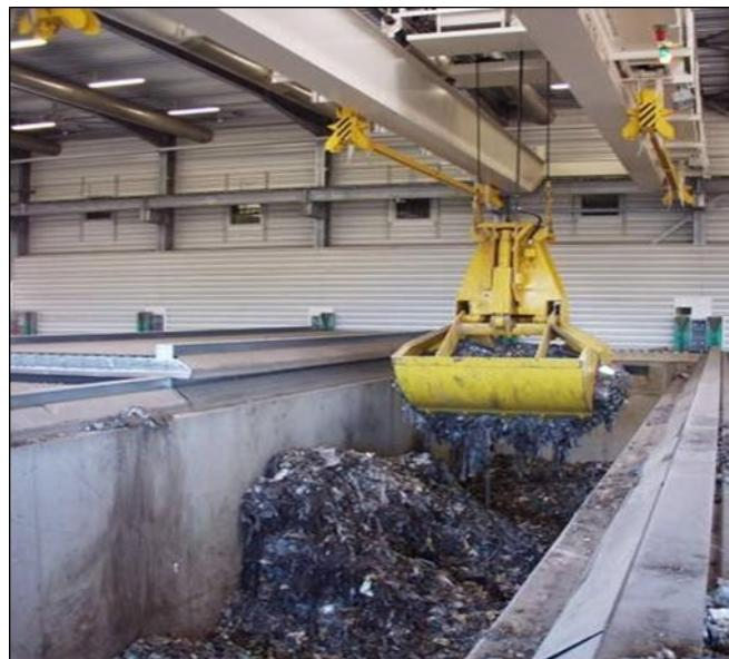
Slika 6. Utovar komore za biosušenje procesnim kranom [9]
