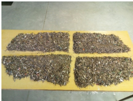
Slika 14. Odabir reprezentativnog uzorka, metodom četvrtanja
