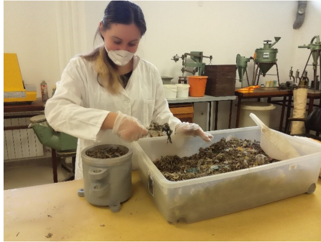
Slika 16. Punjenje kalupa uzorkom
