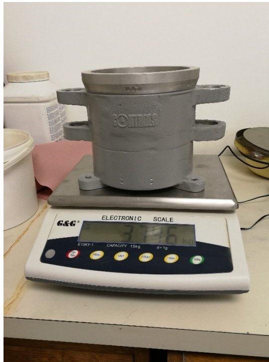
Slika 15. Masa praznog kalupa
