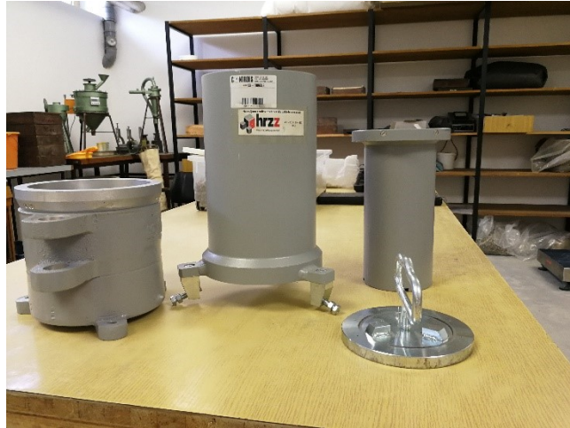
Slika 10. Kalup za određivanje zbijenosti vibro pločom
