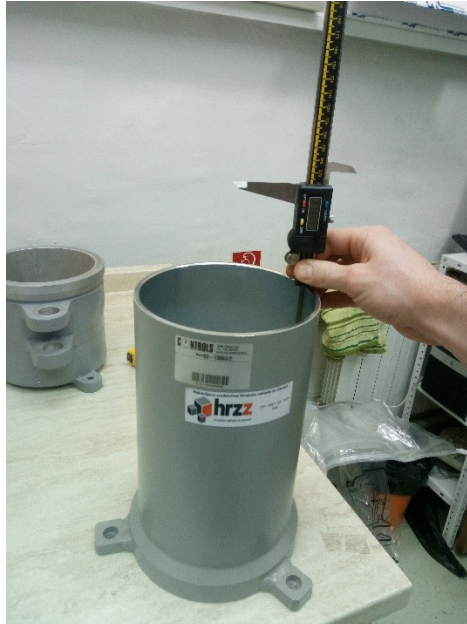
Slika 12. Određivanje visine cilindra iznad kalupa
