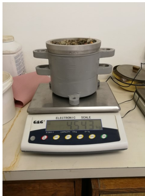
Slika 17. Vaganje kalupa sa uzorkom
