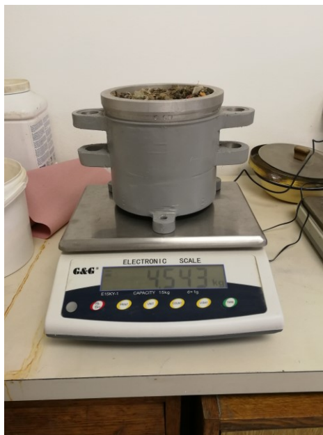
Slika 17. Vaganje kalupa sa uzorkom
