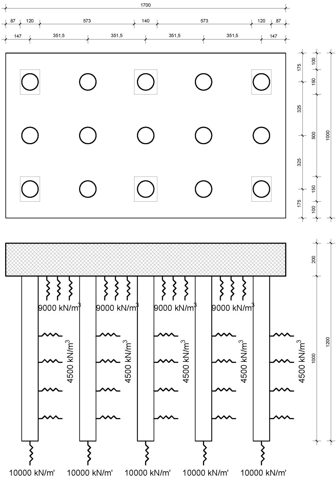
Slika 31. Tlocrtni prikaz kombiniranog temelja temeljne ploče i pilota, te shematski prikaz reakcije podlage za temelj parno-turbinskog agregata.
