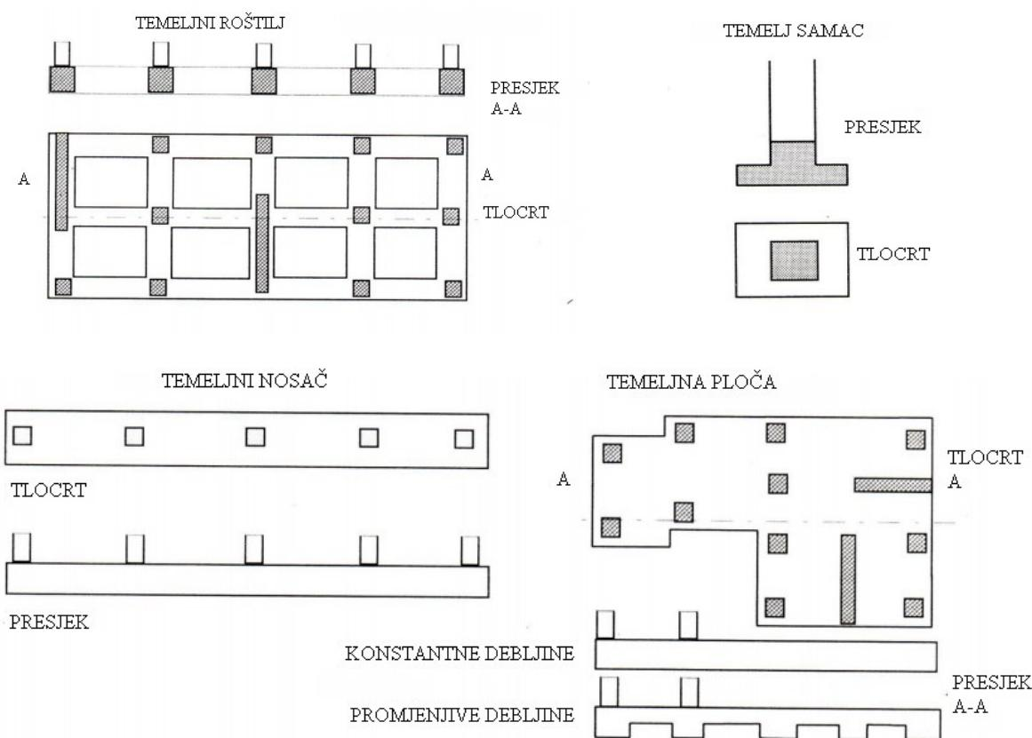
Slika 5. Shematski prikaz podjele plitkih temelja, s tlocrtima i nacrtima
