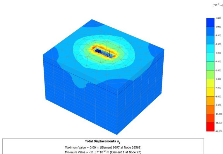
Slikom 24. Konture ukupnog slijeganja u smjeru  $y$  ( $u_y$ ) temelja plinsko-turbinskog agregata.
