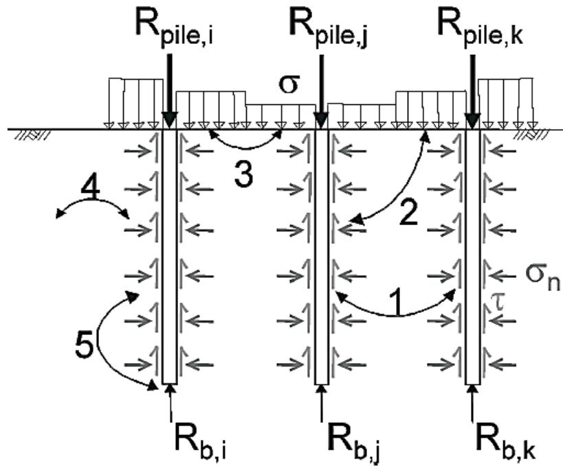
Slika 16. Shematski prikaz međudjelovanja kod kombiniranog temeljenje temeljna ploča – pilot
