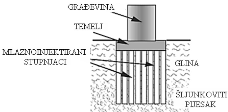
Slika 7. Duboki masivni temelj od mlazno injektiranih stupnjaka
