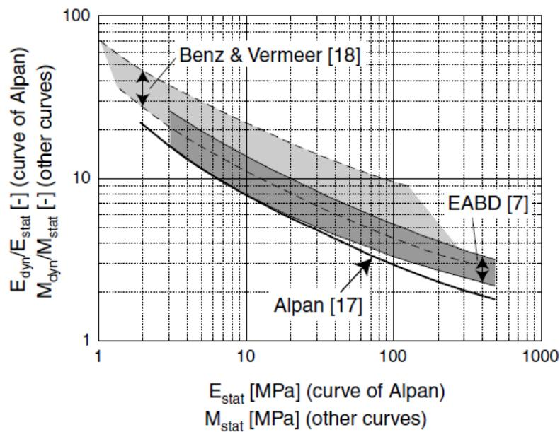
Slika 19. Prikaz dijagraama vrijednosti dinamičkih opterećenja
