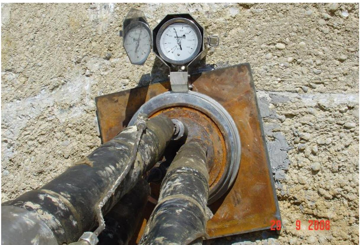
Slika 23. Ugrađeni dinamometar za praćenje sile u sidru [13]
