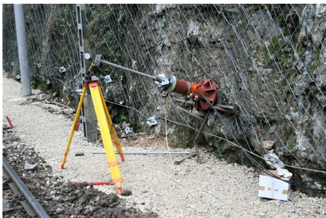
Slika 7. Ispitivanje sidara testom čupanja
