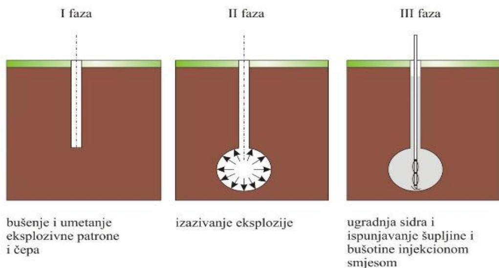
Slika 10. Ugradnja sidra u glinenom tlu [13]
