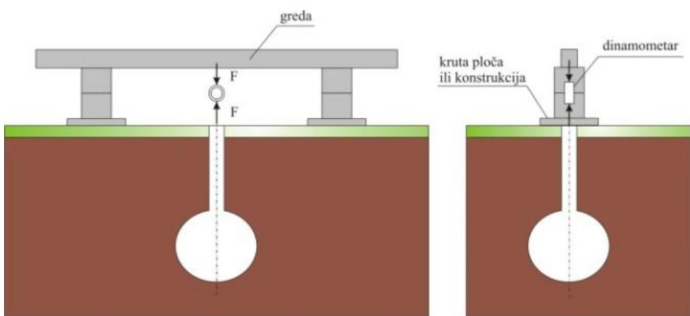
Slika 12. Shematski prikaz kontrole nosivosti ugrađenog sidra [12]
