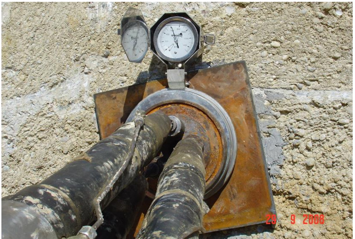
Slika 23. Ugrađeni dinamometar za praćenje sile u sidru [13]
