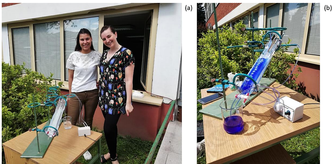
Slika 13 Priprema (a) i provođenje (b) eksperimenata fotokatalitičke razgradnje metilenskog modrila izloženog sunčevom zračenju
