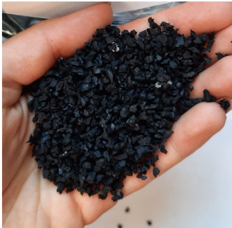
Slika 13. Gumeni granulat veličine 2,0 – 3,5 mm
