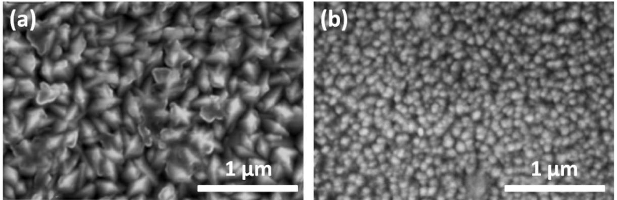
Slika 20. Sken slike  $\text{TiO}_2$  elektronskom mikroskopijom s različitim vremenima taloženja (a) 2 minutu i (b) 1 minute [12]
