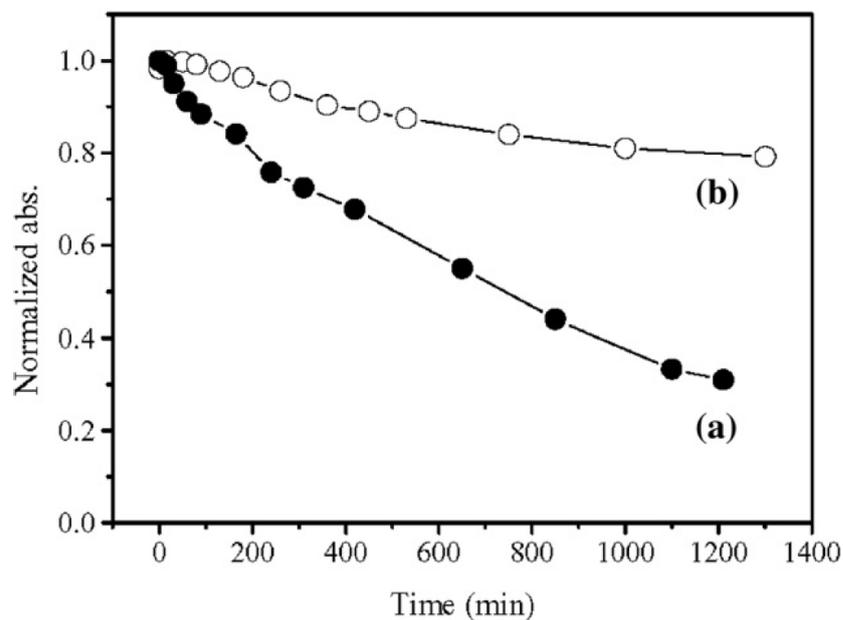
Slika 32. Fotokatalitička razgradnja metilen plavog pomoću uzorka NR presvučenog TiO<sub>2</sub>: (a), u ovisnosti o vremenu osvjetljenja žarulje svjetlosti jačine 1 mW cm<sup>-2</sup>; (b) predstavlja apsorpciju uzorka u mraku [13]
