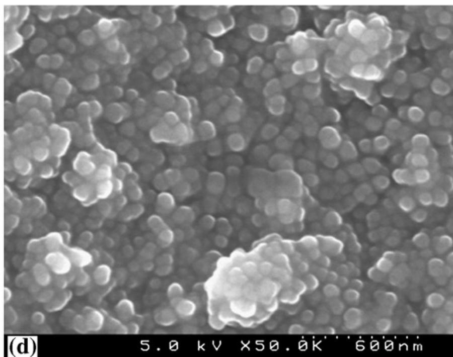
Slika 28. Prirodna gume presvučena slojem  $\text{TiO}_2$  – uvećana slika [13]
