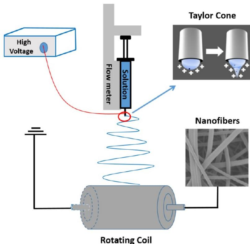
Slika 16. Shematski prikaz metode elektrospinninga [12]
