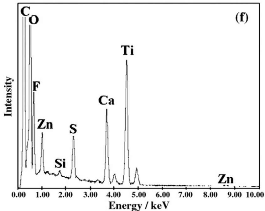
Slika 30. Rezultati EDX koji odgovaraju (c), (Zn, Ca, S i C dolaze iz NR podloge, F dolazi iz reakcijske otopine, a Si dolazi iz sloja SiO<sub>2</sub>) [13]
