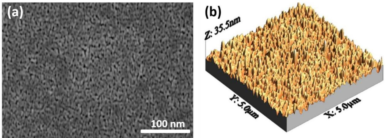
Slika 19. (a) SEM slika TiO<sub>2</sub> tankog filma sintetiziranog premazom i (b) AFM slika (topografski prikaz) TiO<sub>2</sub> tankog filma [12]
