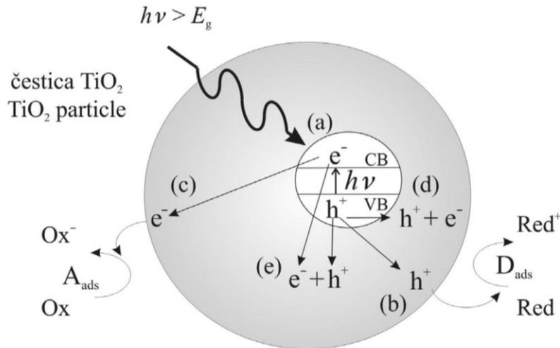
Slika 4. Glavni procesi u čestici poluvodiča  $\text{TiO}_2$ : (a) nastajanje para elektron-šupljina, (b) oksidacija adsorbirane molekule D, (c) redukcija adsorbirane molekule A, (d) rekombinacija na površini čestice, (e) rekombinacija u unutrašnjosti čestice [6]
