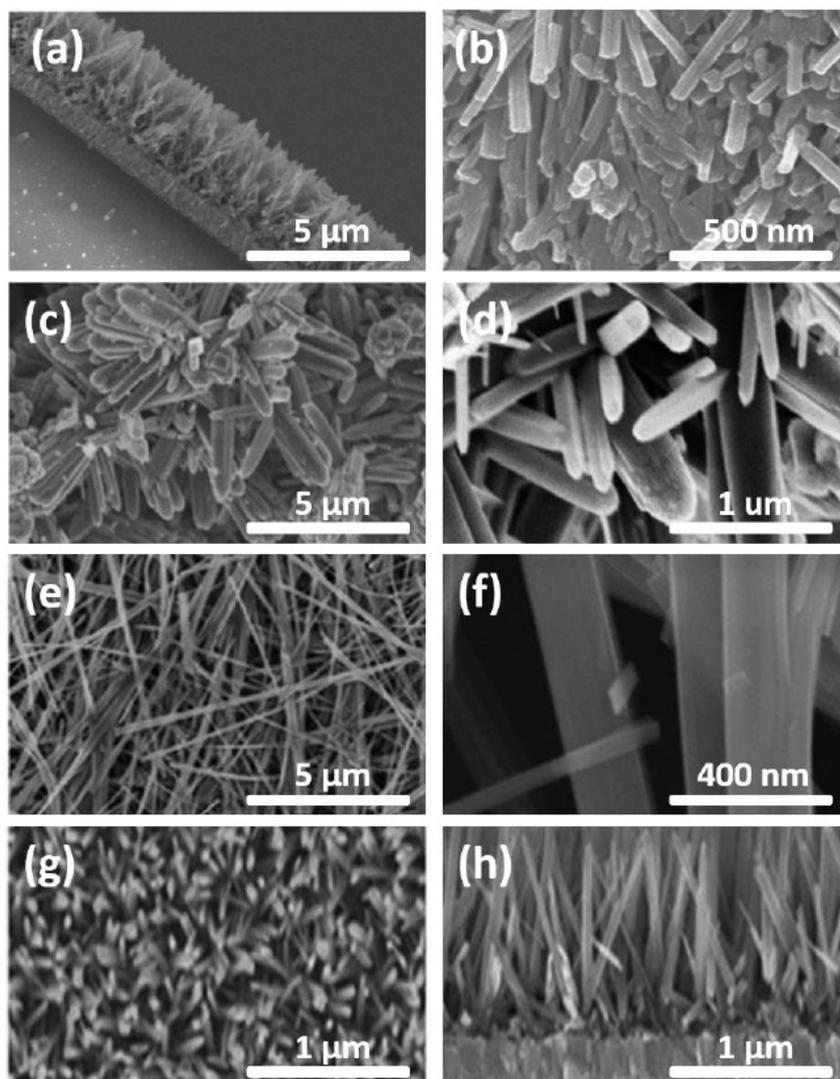
Slika 17. Različite vrste morfologije 1D TiO<sub>2</sub> nanostrukture sintetiziranih hidrotermalnim metodama: (a, b) TiO<sub>2</sub> nanocijevi, (c, d) TiO<sub>2</sub> nanočepići, (e, f) TiO<sub>2</sub> nano trake, (g, h) TiO<sub>2</sub> nanožice [12]
