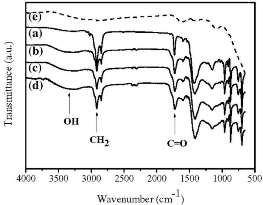
Slika 24. ATR-FT-IR spektri površina prirodne gume: (a), netretirani NR; (b), NR tretiran UV/ozonom 20 min, (c), 40 min, (d), 60 min, (e) predstavlja spektar NR presvučenog TiO<sub>2</sub> uzorka [13]
