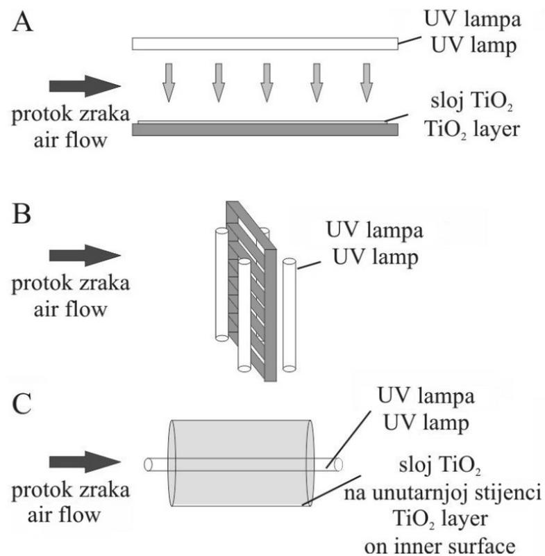
Slika 5. Shematski prikaz raspodjela fotokatalitičkih reaktora s obzirom na smjer reakcije, položaja UV-lampe i smještaj katalizatora: (a) tip reaktora s ravnom pločom, (b) sačasti monolitni tip reaktora i (c) cijevni (anularni) reaktor [4]
