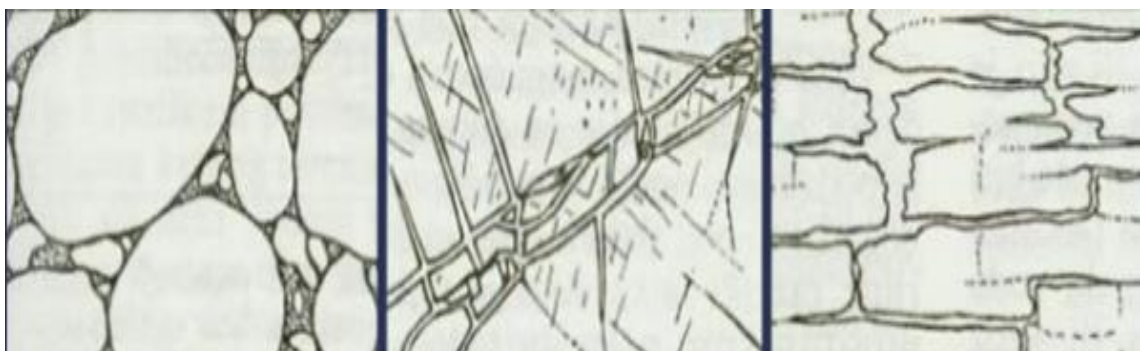
Slika 2. Tipovi poroznosti: intergranularna, pukotinska i pukotinsko-kavernozna
