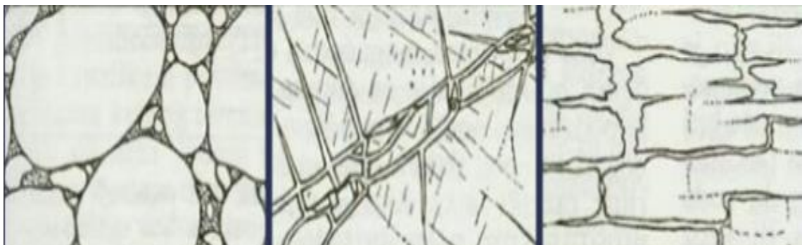
Slika 2. Tipovi poroznosti: intergranularna, pukotinska i pukotinsko-kavernozna
