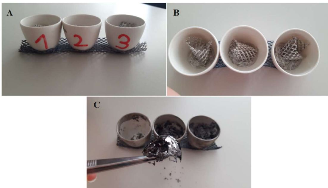
Slika 13 Odvagnuti uzorci PET-a. (A,B – prije pirolize; C – nakon pirolize).
