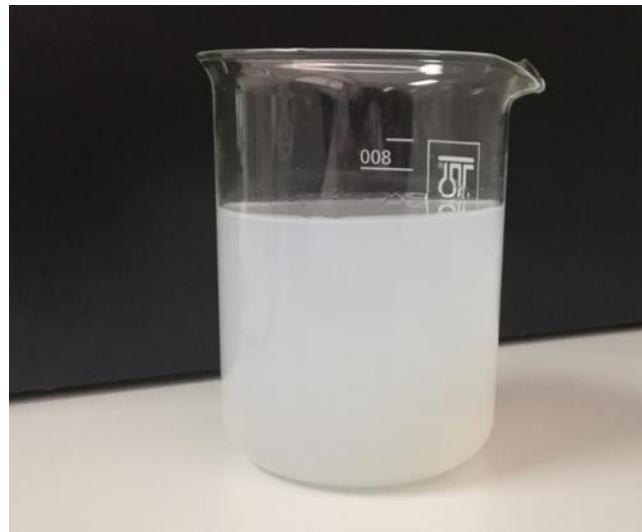
Slika 16 Suspenzija  $\text{TiO}_2$
