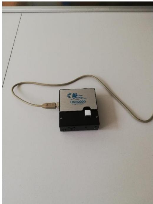
Slika 30 Prijenosni spektrofotometar Ocean Optics USB2000+
