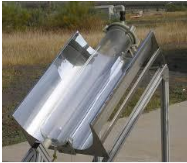
Slika 18 „CPC – SODIS“ fotoreaktor [61]
