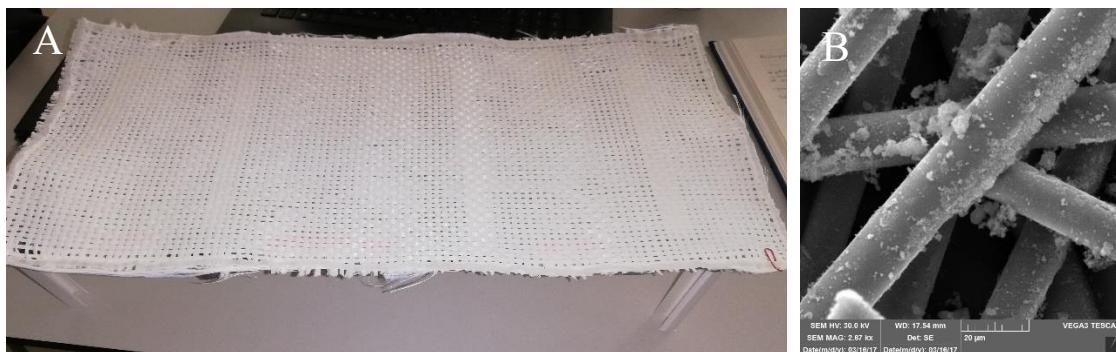
Slika 22 (A) Originalna mreža s nanesenim  $\text{TiO}_2$ ; (B) SEM slika mreže s nanesenim  $\text{TiO}_2$
