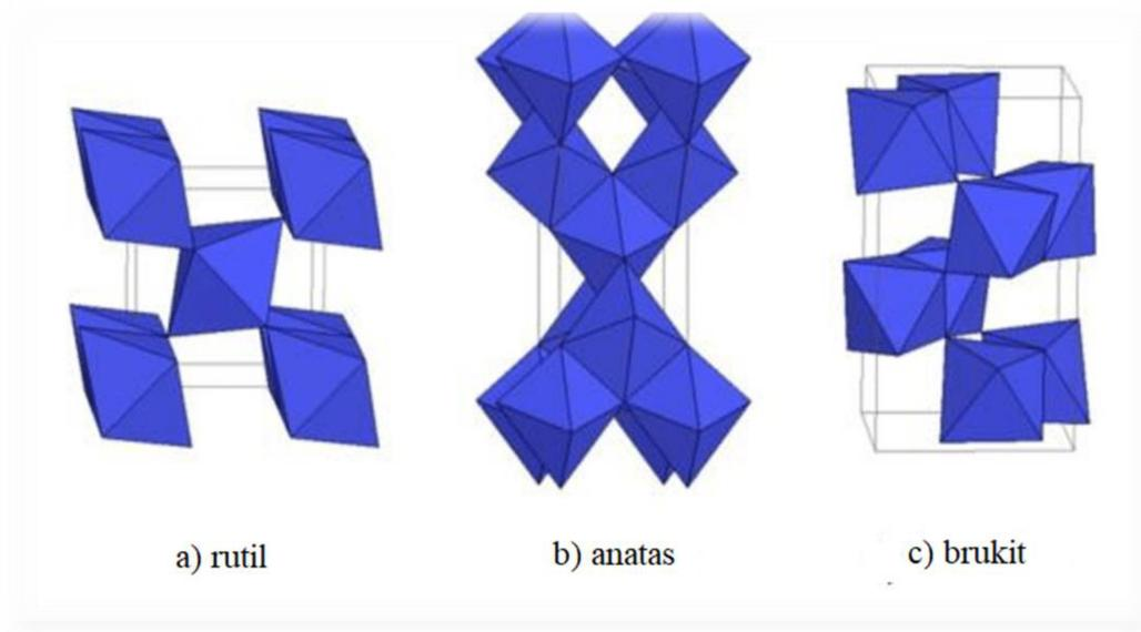
Slika 14 Kristalne strukture titanova (IV) oksida [51]
