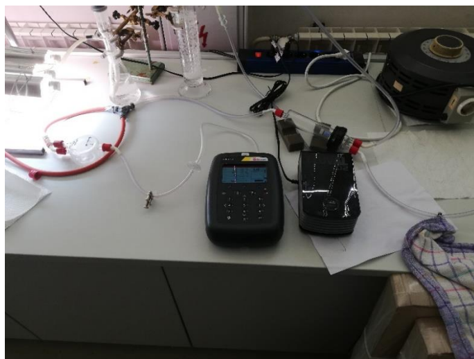
Slika 29 Eksperimentalni postav fotokatalitičke oksidacije amonijaka – sa recirkulacijom plina u sustavu
