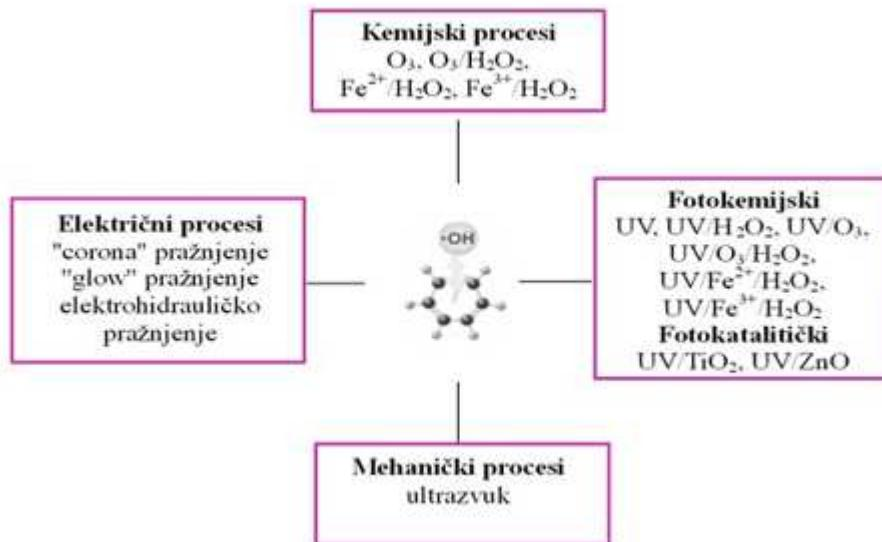
Slika 10 Shematski prikaz naprednih oksidacijskih procesa [38]
