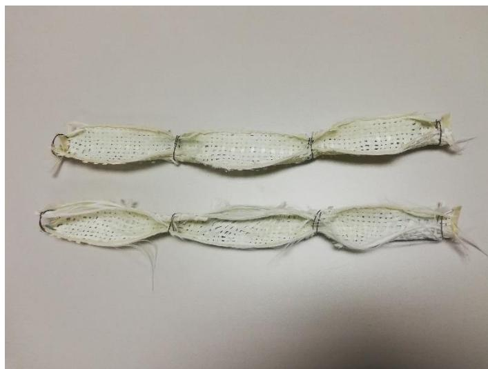
Slika 23 Izrezani fotokatalizator korišten u CPC reaktoru
