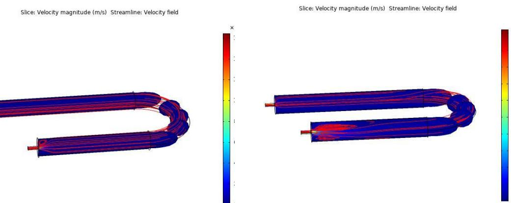
Slika 46 Grafički prikaz simulacije fluida kroz CPC reaktor – sa vodom (lijevo) i sa zrakom (desno)
