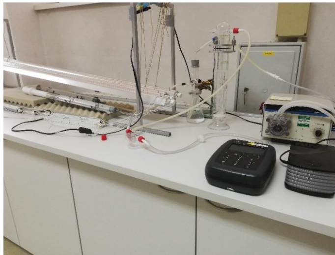
Slika 28 Eksperimentalni postav fotokatalitičke oksidacije amonijaka – bez recirkulacije plina u sustavu
