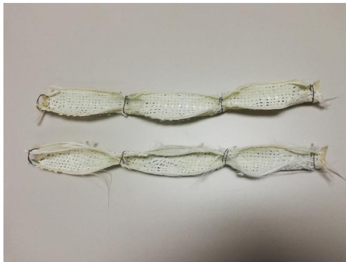
Slika 23 Izrezani fotokatalizator korišten u CPC reaktoru
