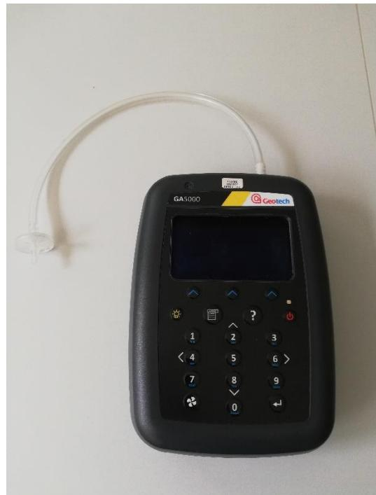
Slika 32 Uređaj za mjerjenje plinova Geotech GA5000
