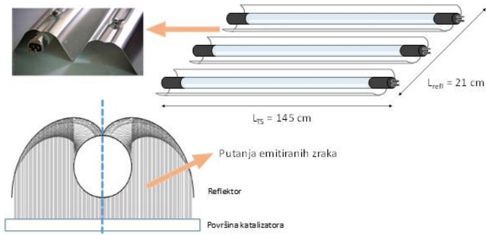
Slika 25 Slika i shematski prikaz korištenih lampa
