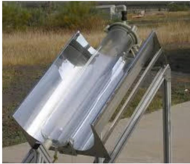
Slika 18 „CPC – SODIS“ fotoreaktor [61]
