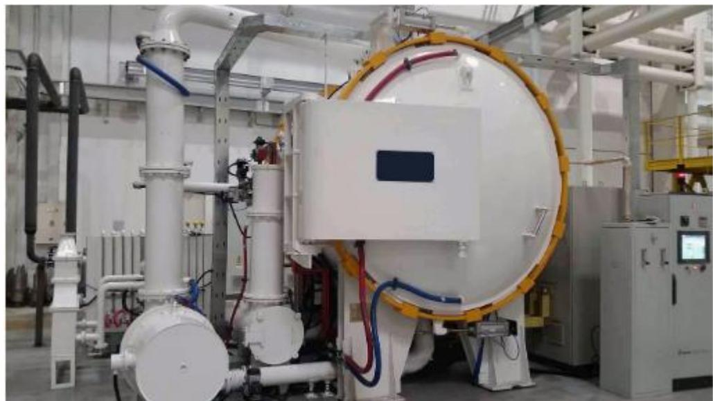
Slika 3 Vakuumska horizontalna jednokomorna peć [6]
