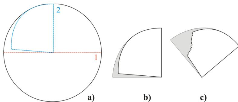
**Slika 18.** Shematski prikaz načina savijanja filter papira [20]
