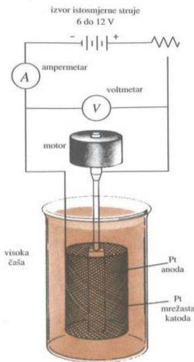
**Slika 23.** Uredaj za elektrotaloženje metala bez kontrole potencijala katode [2]
