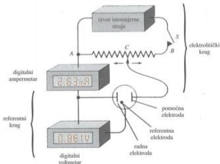
**Slika 24.** Uređaj za elektrolizu uz kontrolu potencijala [2]
