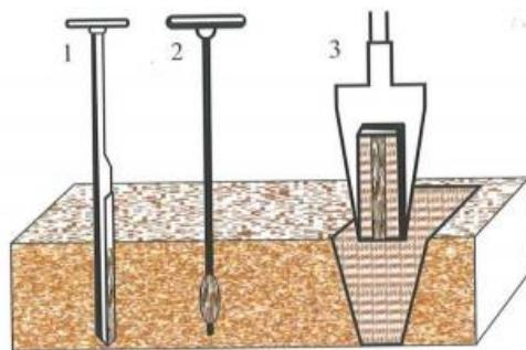
Slika 6. Uzorkovanje tla: 1) svrdlima, 2) ručnim sondama, 3) lopatama [5]
