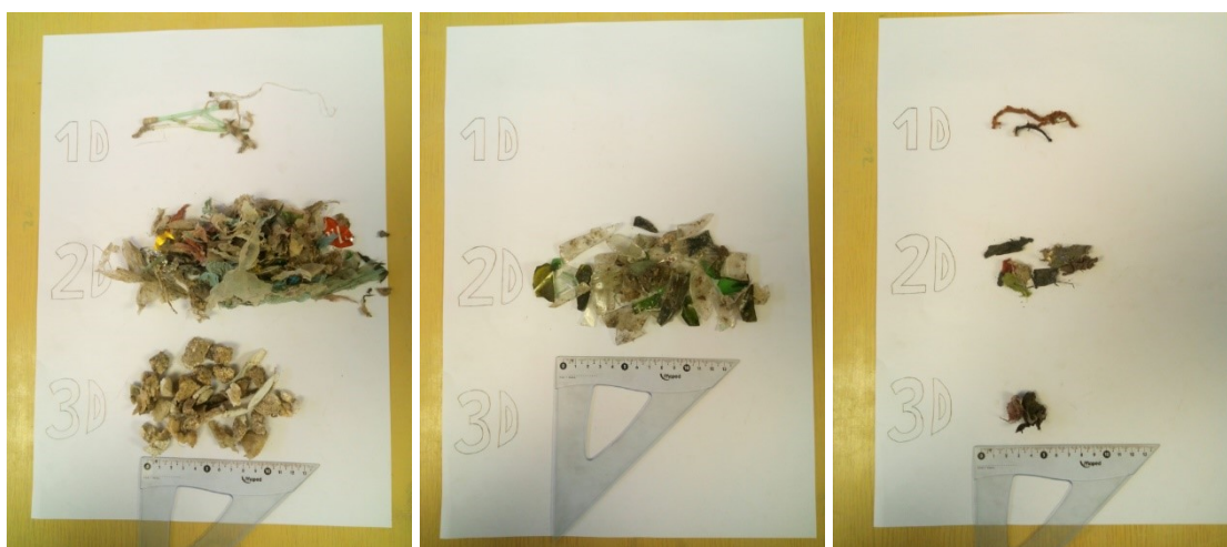
Slika 8: Komponente uzorka razdvojene prema obliku (s lijeve na desno: plastika, staklo, tekstil)
