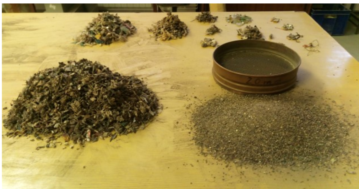
Slika 10: Uzorak iz ŽCGO Mariščina razdvojen na komponente
