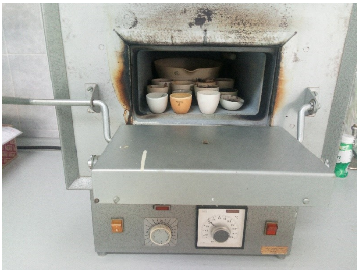
Slika 6: Uzorak u mufolnoj peći
