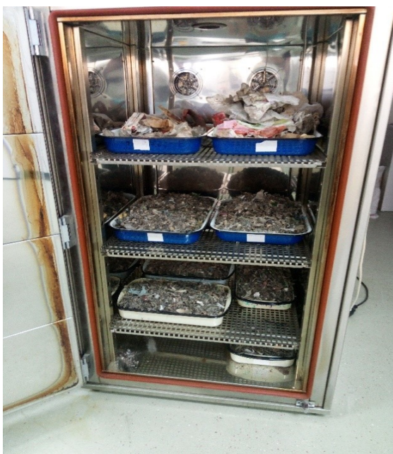
Slika 9: Reprezentativni uzorak pripremljen za sušenje
