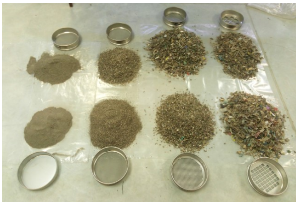
Slika 12: Sita i prosijani uzorci
