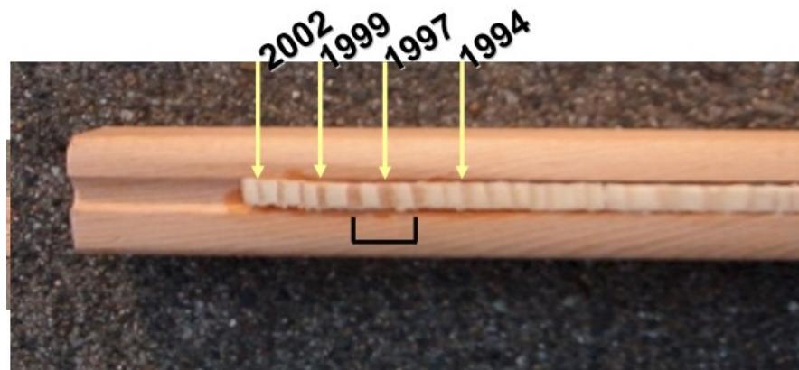
Slika 6. Uzorak uzet iz drveta (Dating Techniques)
