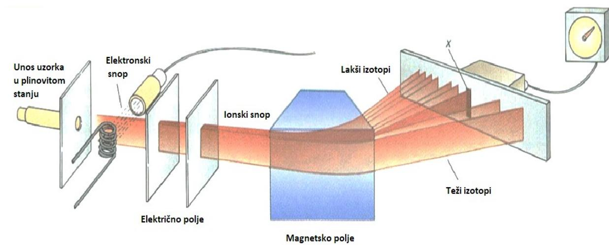
Slika 5. Maseni spektrometar s magnetskim analizatorom (Davina Linehan)
