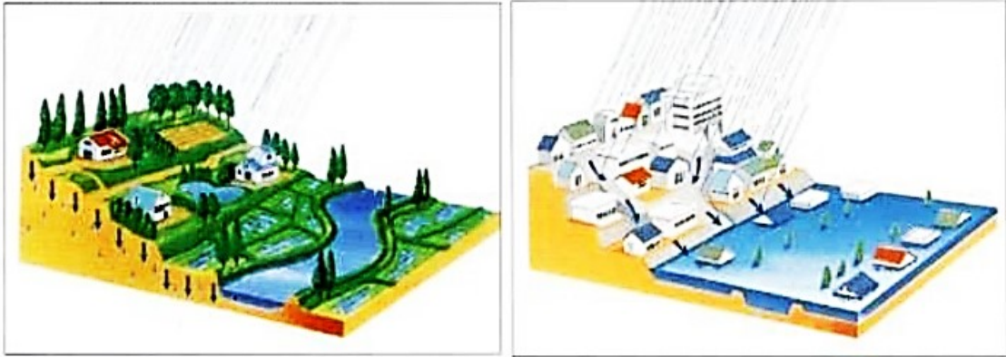
Slika 6. Pluvijalno podrijetlo poplava (slika lijevo – prije urbanizacije područja; slika desno – nakon urbanizacije područja)
