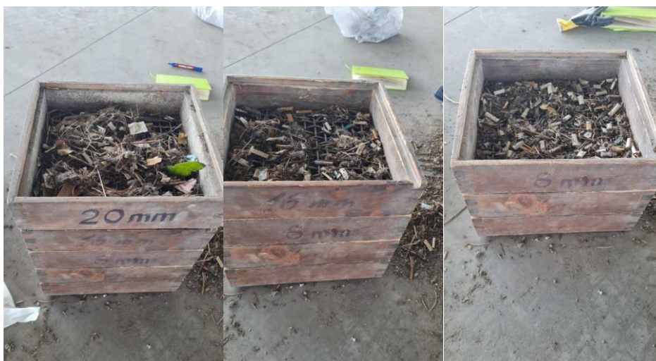
Slika 16. Prikaz razdvajanja otpada na frakcije pomoću sita
