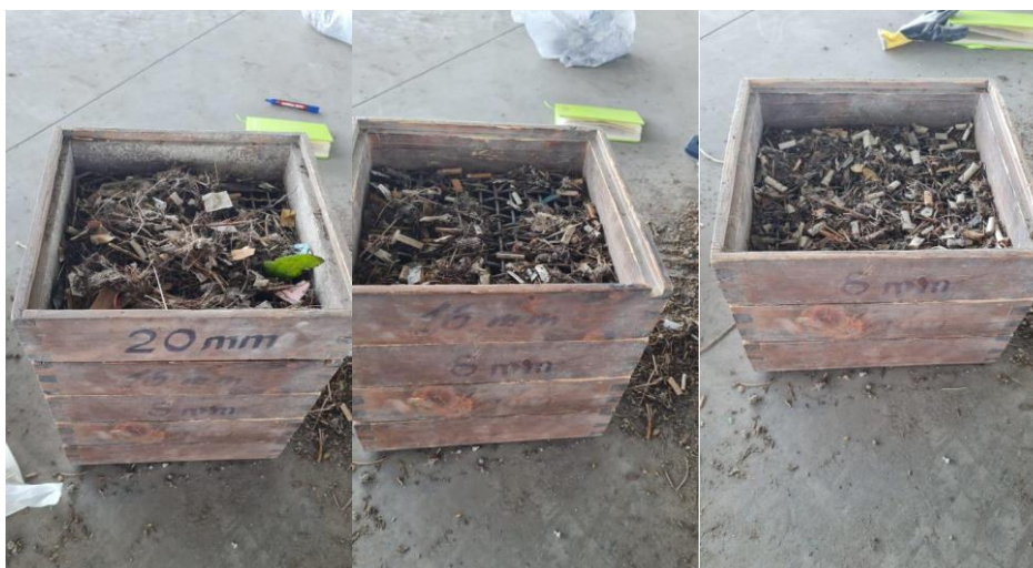
Slika 16. Prikaz razdvajanja otpada na frakcije pomoću sita
