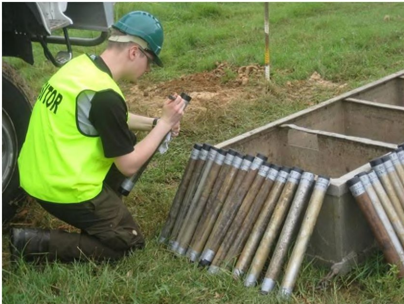
Slika 16 - Označavanje neporemećenih uzoraka tla na terenu [10]
