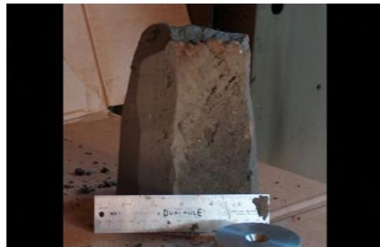
**Slika 13** - Uzorak bloka stijene u laboratoriju prije isjecanja ispitnog uzorka [7]
