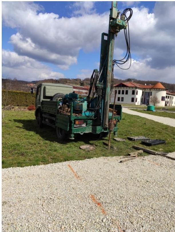
**Slika 6** - Primjer hidrauličnog bušačeg postrojenja (marka CLIVIO) smještenog na terensko vozilo (Mercedes 4x4), Pregrada RH (autor: J. Jug, 2021.)
