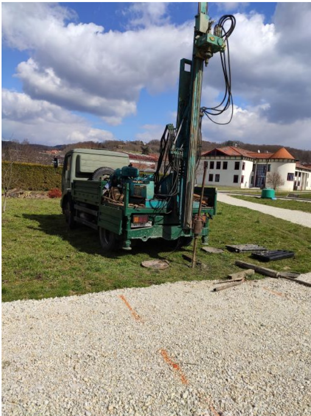
Slika 6 - Primjer hidrauličnog bušaćeg postrojenja (marka CLIVIO) smještenog na terensko vozilo (Mercedes 4x4), Pregrada RH (autor: J. Jug, 2021.)
