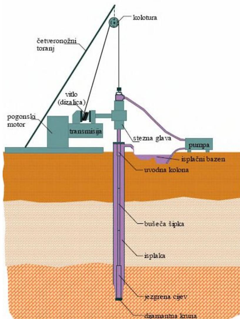
Slika 7 - Primjer rotacijskog jezgrenog bušenja [6]
