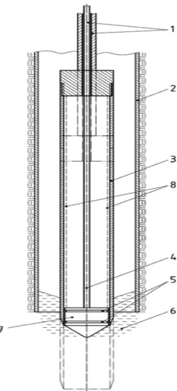
**Slika 11** - Shematski prikaz klipnog uzorkivača tankih stijenki kod operacije uzorkovanja sa dna bušotine [3]
