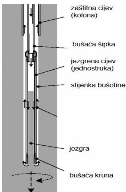
**Slika 4 - Rotacijsko bušenje s kontinuiranim jezgrovanjem [1]**
