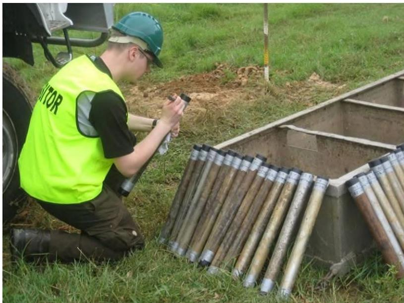
**Slika 16 - Označavanje neporemećenih uzoraka tla na terenu [10]**
