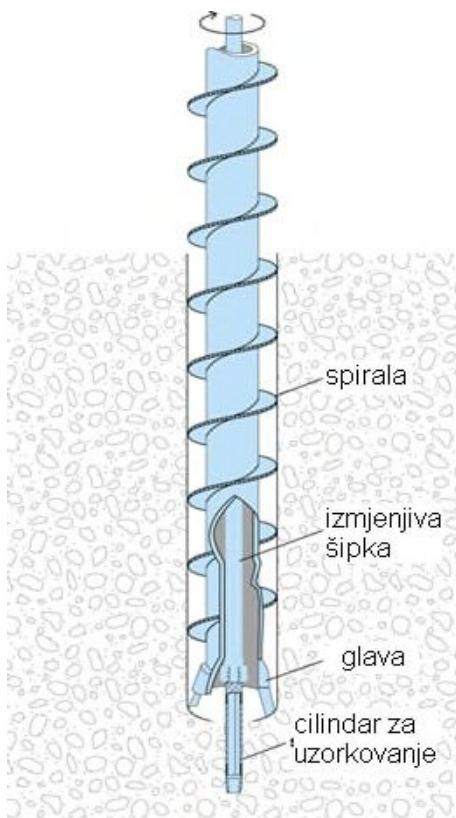
**Slika 3 - Primjer spiralnog svrdla za rotacijsko bušenje [6]**
