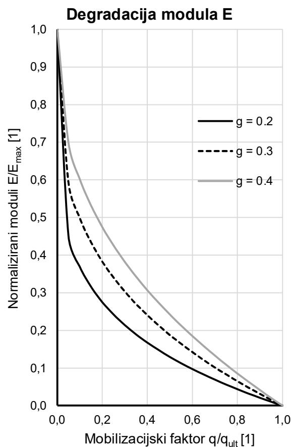
**Slika 7** Krivulje degradacije modula elastičnosti  $E$  za geostatičke proračune
