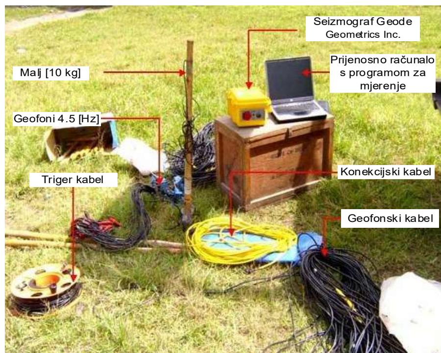
**Slika 4** Oprema za terensko mjerjenje SRF i MASW metodom (researchgate.net, 2006)
