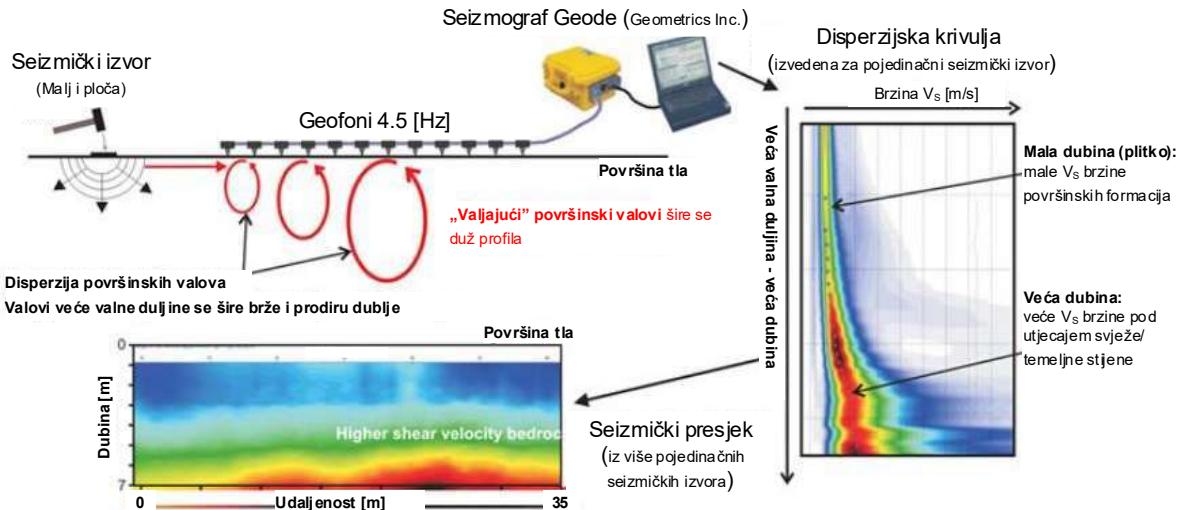
**Slika 14** Shematski prikaz mjerjenja MASW metodom: prikupljanje podataka, obrada podataka i konačna interpretacija – seizmički presjek promjena brzine S valova. (js.com.tr, 2021)
