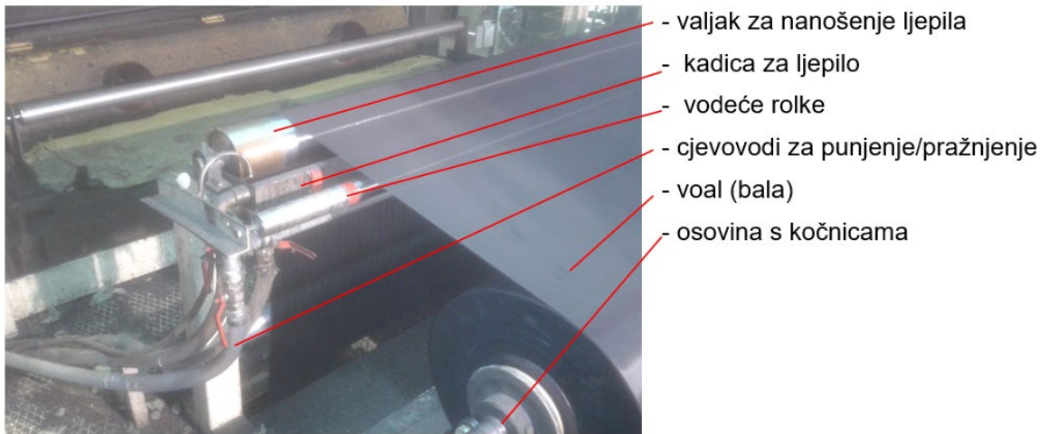
Slika 10. Kaširanje kroz sušionu komoru
