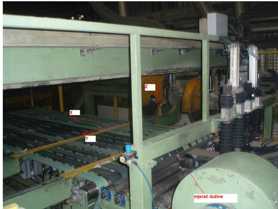
Slika 8. Dvostruka poprečna pila (razrez ploča po dužini)
