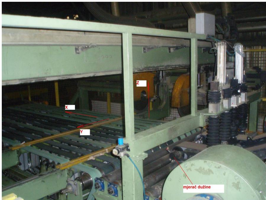
**Slika 8. Dvostruka poprečna pila (razrez ploča po dužini)**
