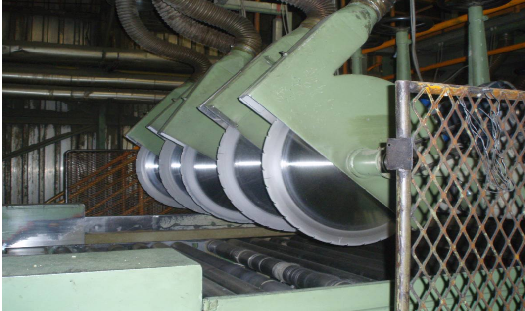
Slika 7. uzdužne pile za razrez po širini
