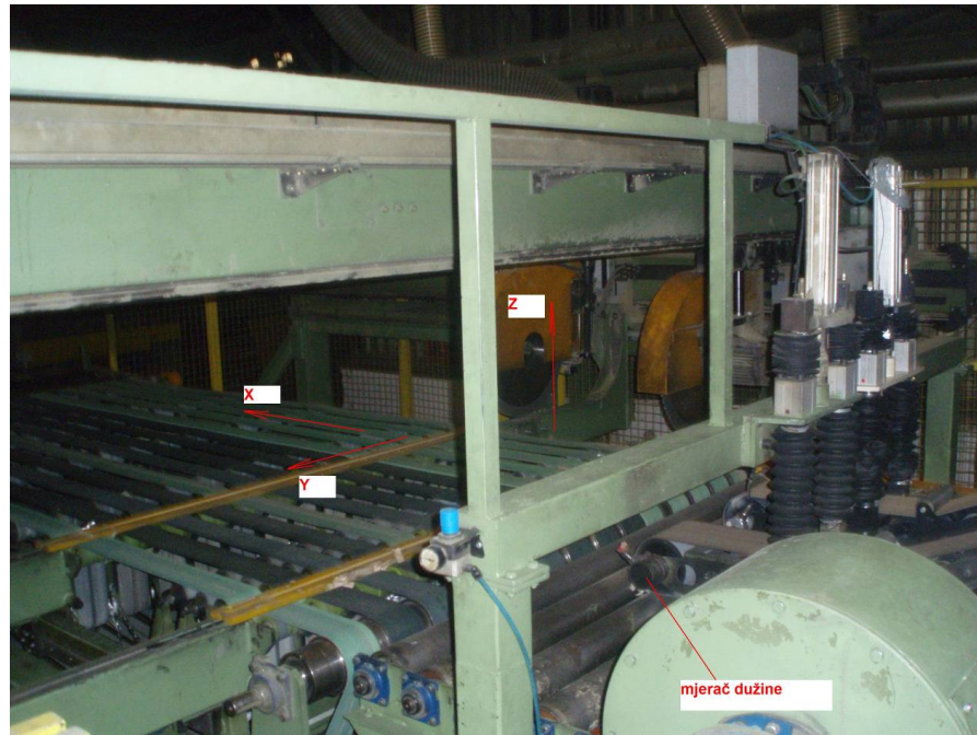
Slika 8. Dvostruka poprečna pila (razrez ploča po dužini)
