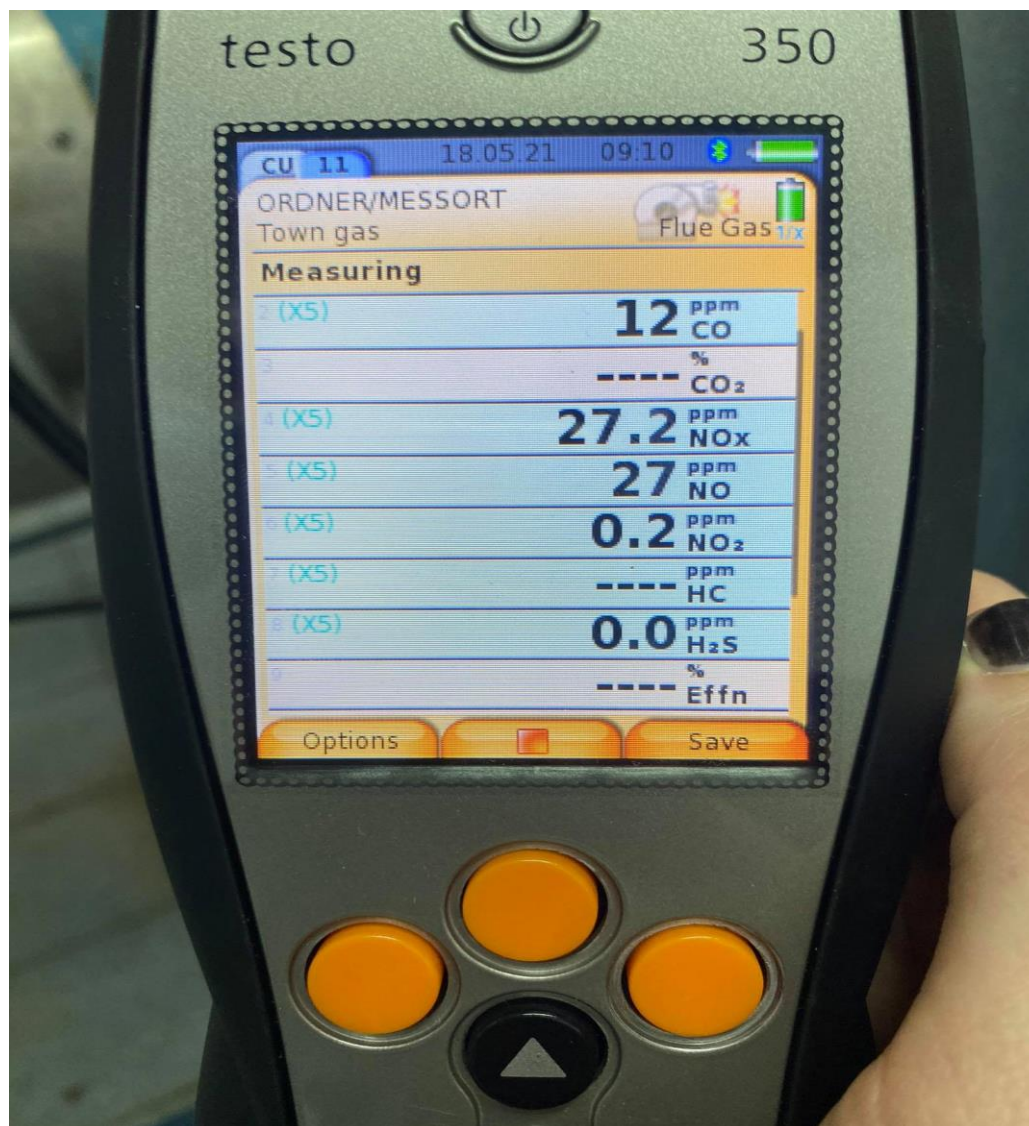
Slika 12. Očitavanje rezultata mjerenja emisije dimnih plinova
