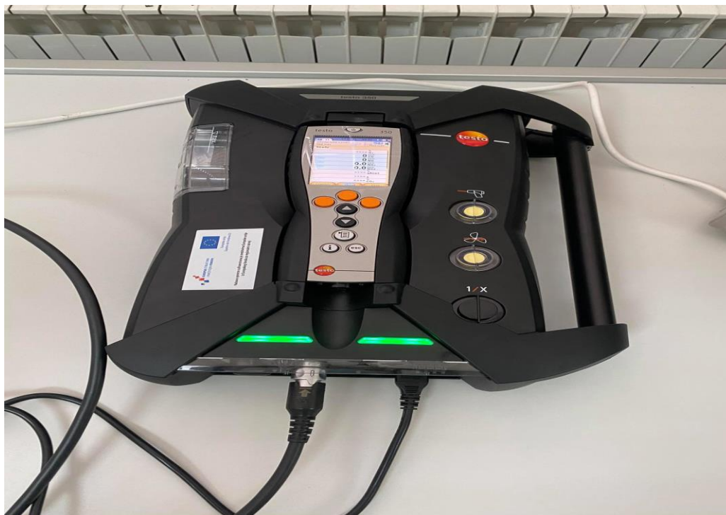
Slika 6. Analizator otpadnih plinova Testo 350
