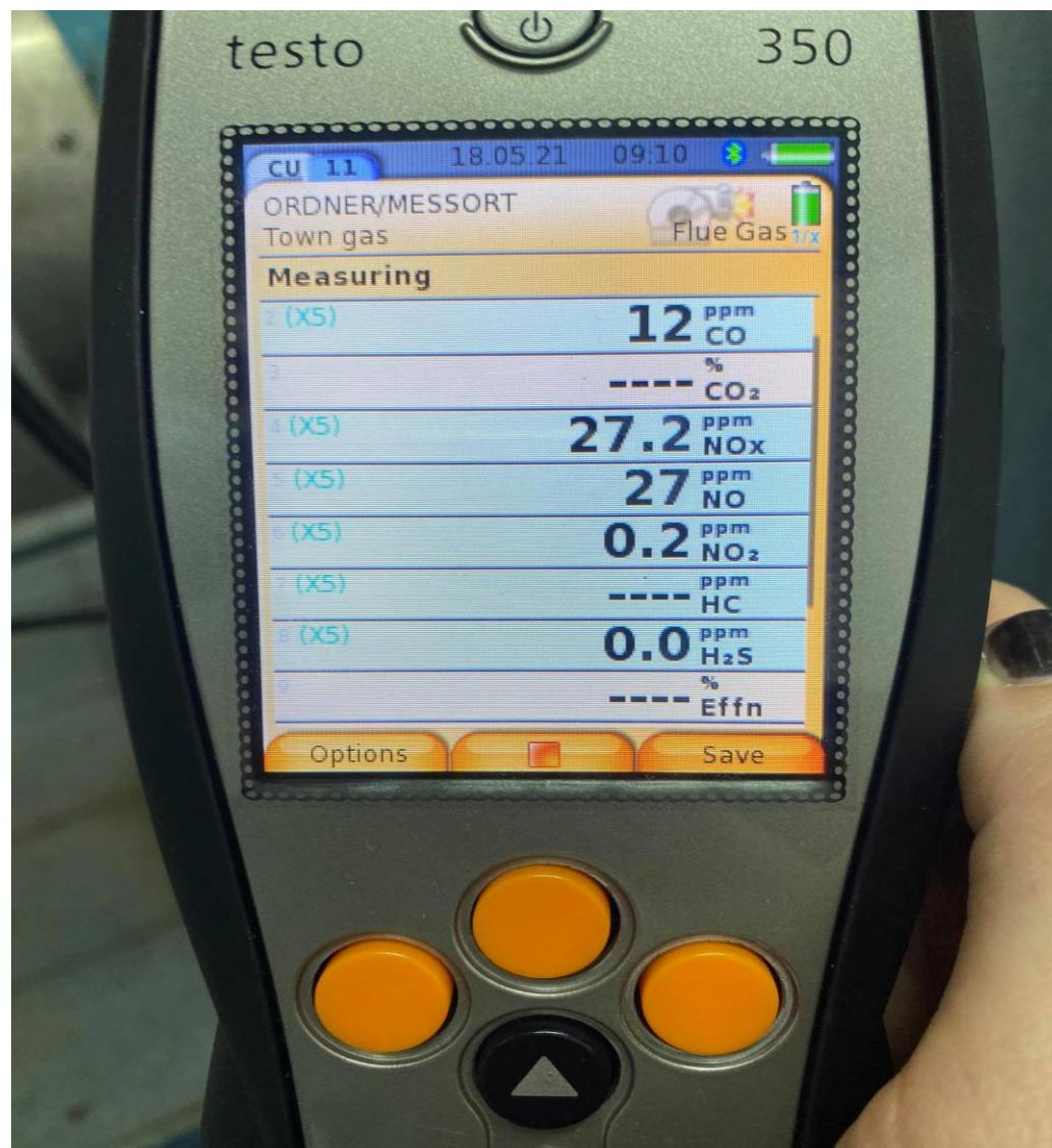
Slika 12. Očitanje rezultata mjerjenja emisije dimnih plinova
