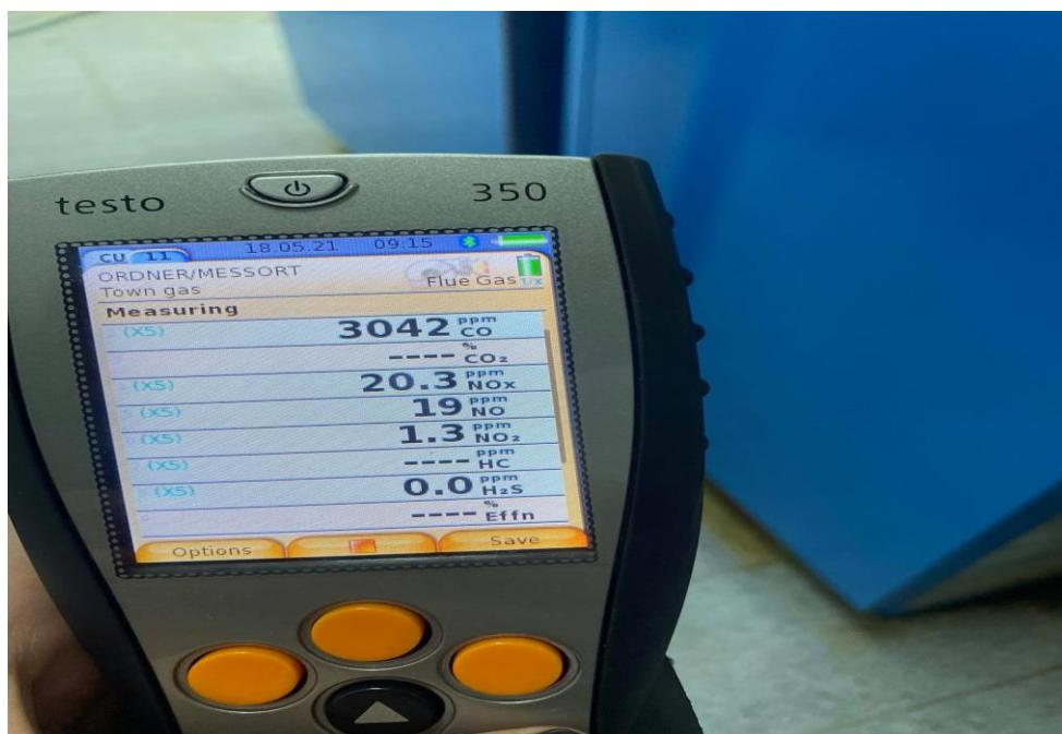
Slika 15. Očitanje dimnih plinova tijekom uključivanja drugog kotla
