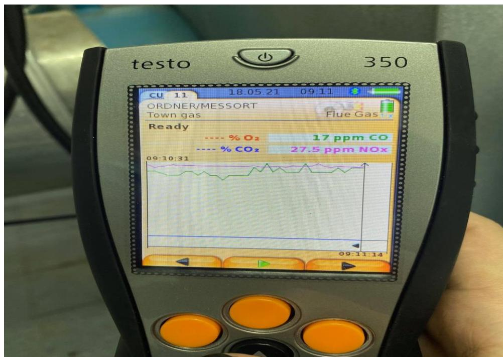
Slika 13. Krivulja emisije CO i NO<sub>X</sub> dobivena mjerjenjem na prvom kotlu
