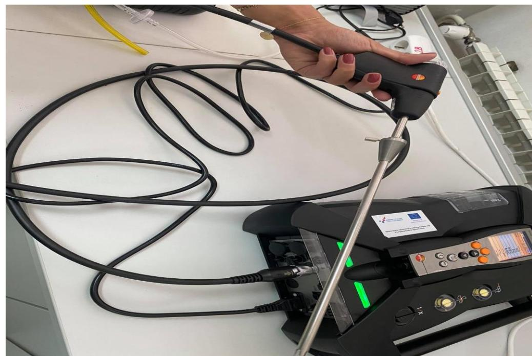
Slika 7. Sonda analizatora Testo 350 za mjerjenje dimnih plinova na ispustu
