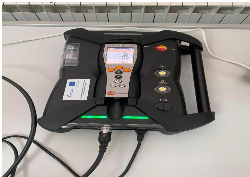
Slika 6. Analizator otpadnih plinova Testo 350
