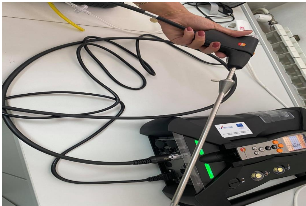
Slika 7. Sonda analizatora Testo 350 za mjerenje dimnih plinova na ispustu
