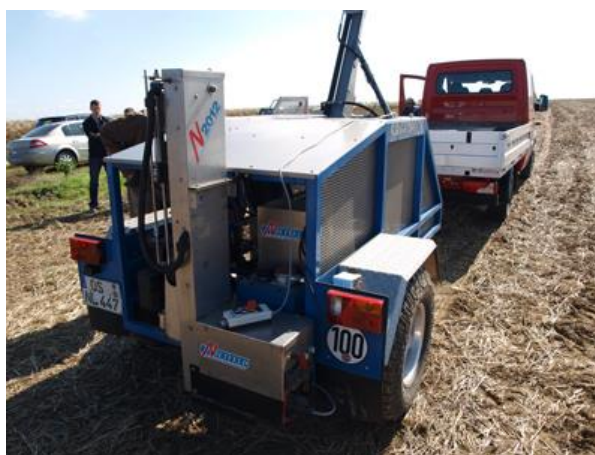
Slika 13. Uređaj N 2012 za strojno uzorkovanje [32]
