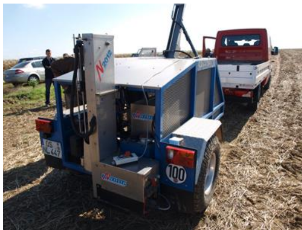
Slika 13. Uređaj N 2012 za strojno uzorkovanje [32]
