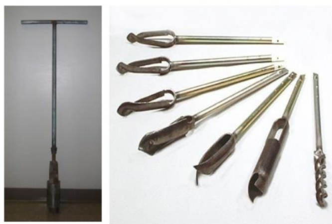
Slika 15. Cjevaste i žljebaste sonde za uzorkovanje tla [34]
