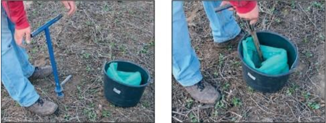
Slika 22. Utiskivanje sonde u tlo i istiskivanje uzorka u vrećicu [43]
