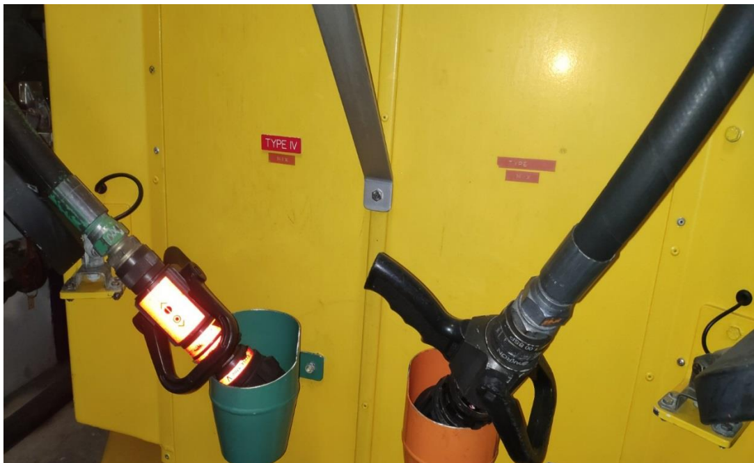
Slika 7: : Mlaznice za raspršivanje sredstva za odleđivanje Izvor: Autor
