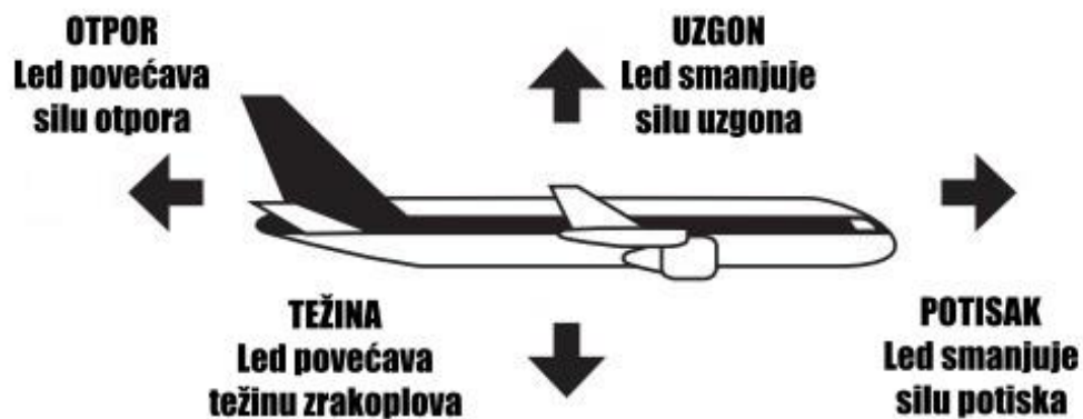
Slika 5: Utjecaj nakupljenog leda na performanse zrakoplova Izvor: Autor
