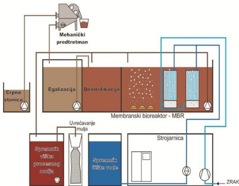
Slika 5. Prerada otpadnih voda membranskim bioreaktorom (MBR) [2]
