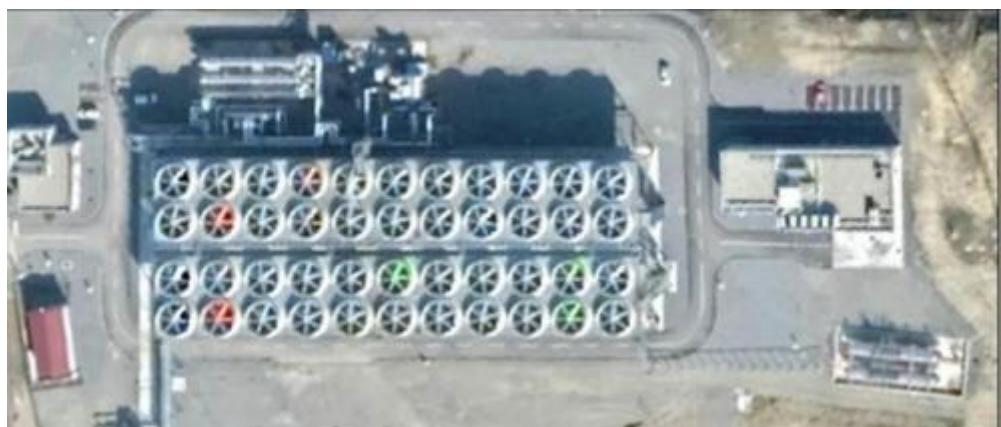
Slika 20. Zračni kondenzator modularnih jedinica radnog medija (Geotermalna elektrana Velika Ciglena) (preuzeto s: <https://mingor.gov.hr/>)
