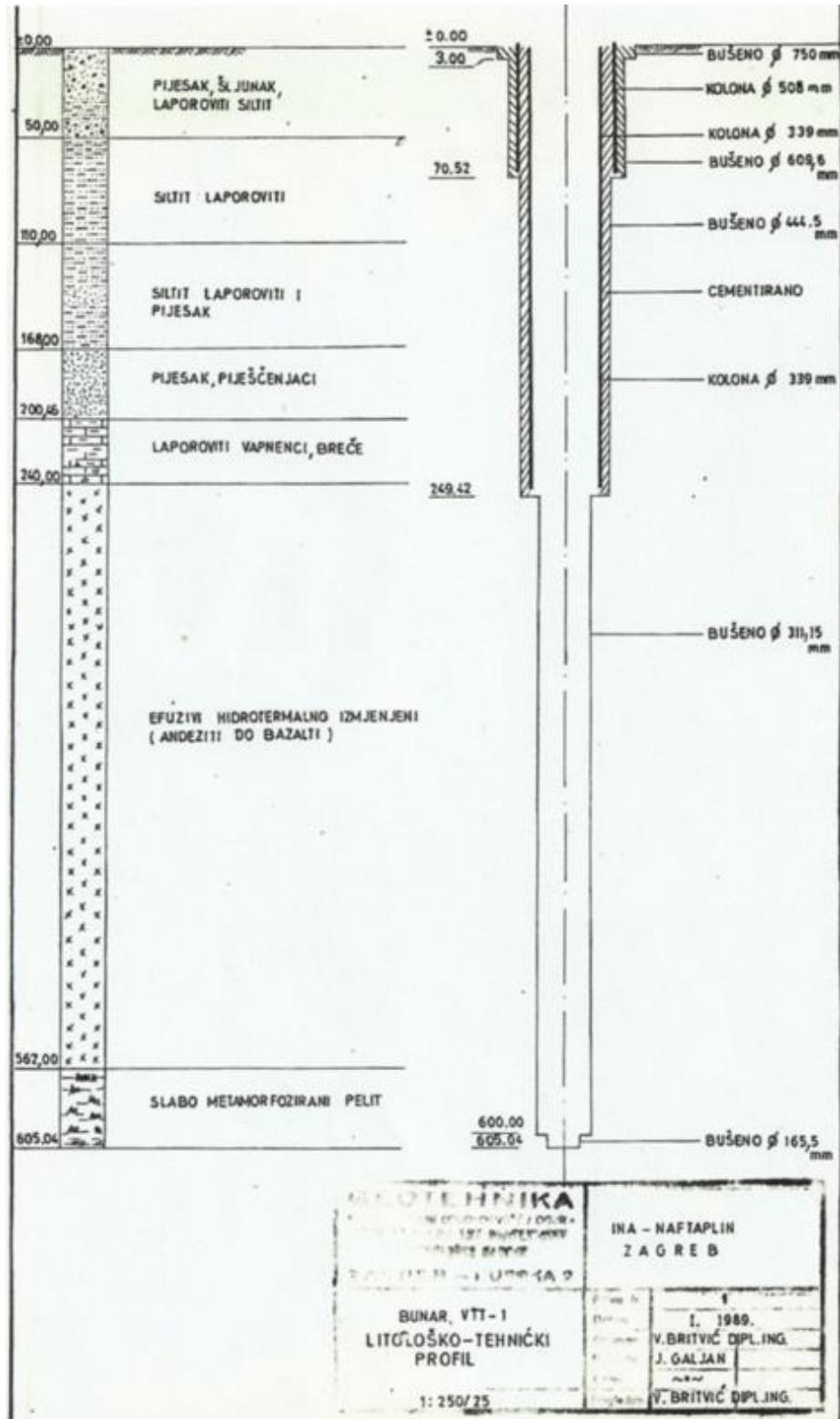
Slika 11 Litološko-tehnički profil bušotine VTT-1 (Škrlec, 2020)
