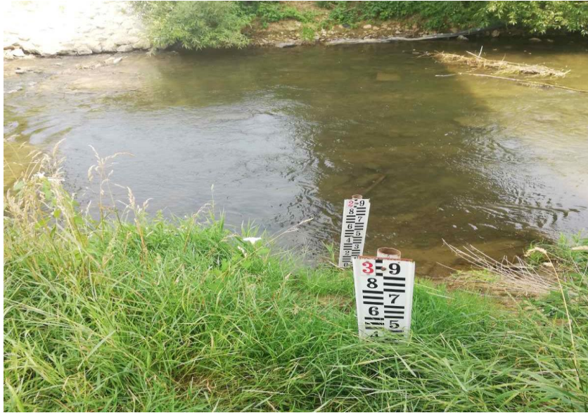
Slika 5. Pojedinačne vodokazne letve u rasponu od 0 do 300 cm na HP Tuhovec (autorska fotografija, 13.7.2021.)
