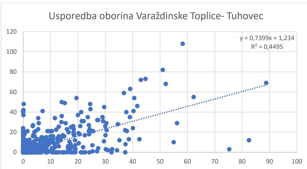
Slika 15. Usporedba dnevnih oborina na kišomjernoj postaji Varaždinske Toplice i vlastitih mjerena u Tuhovcu
