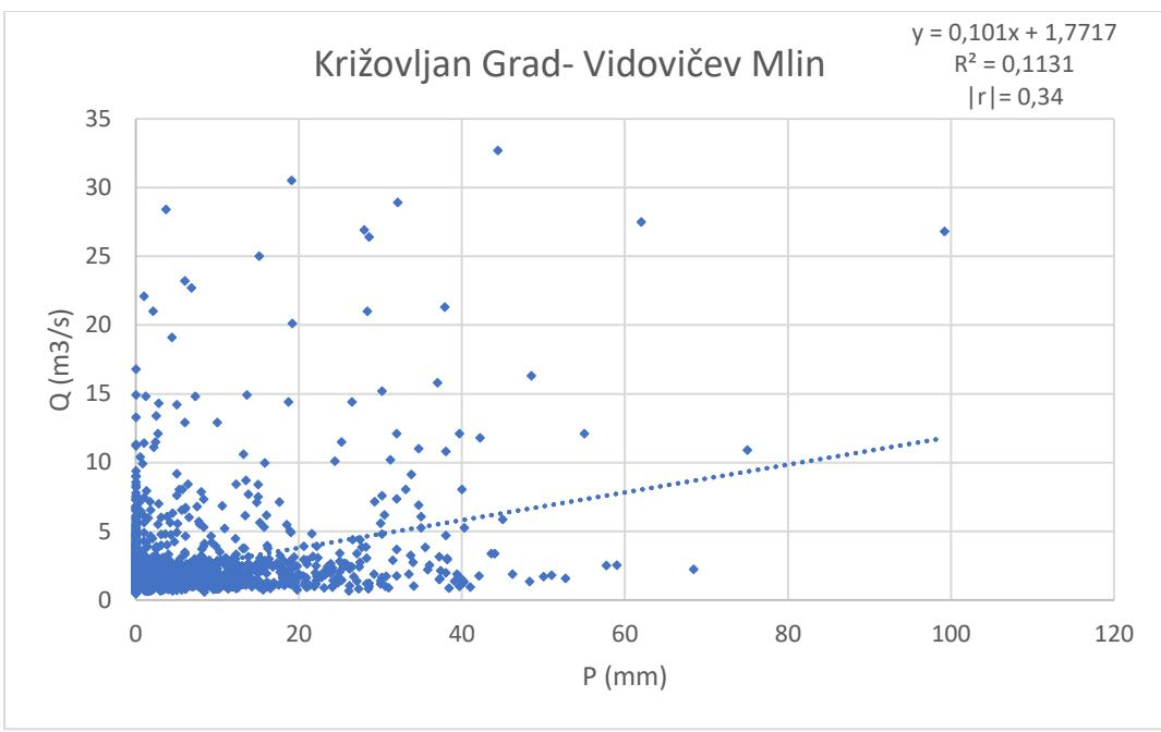
Slika 29. Korelacijska analiza oborina i protoka s kišomjerne postaje Križovljjan Grad i hidrološke postaje Vidovičev Mlin u razdoblju od 2003. do 2019.
