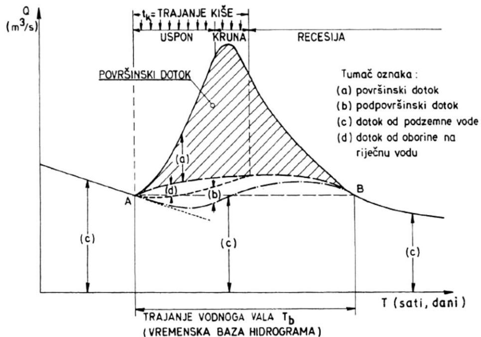
Slika 6. Glavni dijelovi hidrograma otjecanja (Žugaj, 2000).
