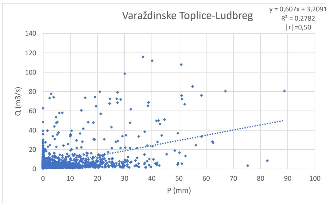
Slika 25. Korelacijska analiza oborina i protoka na kišomjernoj postaji Varaždinske Toplice i hidrološkoj postaji Ludbreg u razdoblju od 2000. do 2019.
