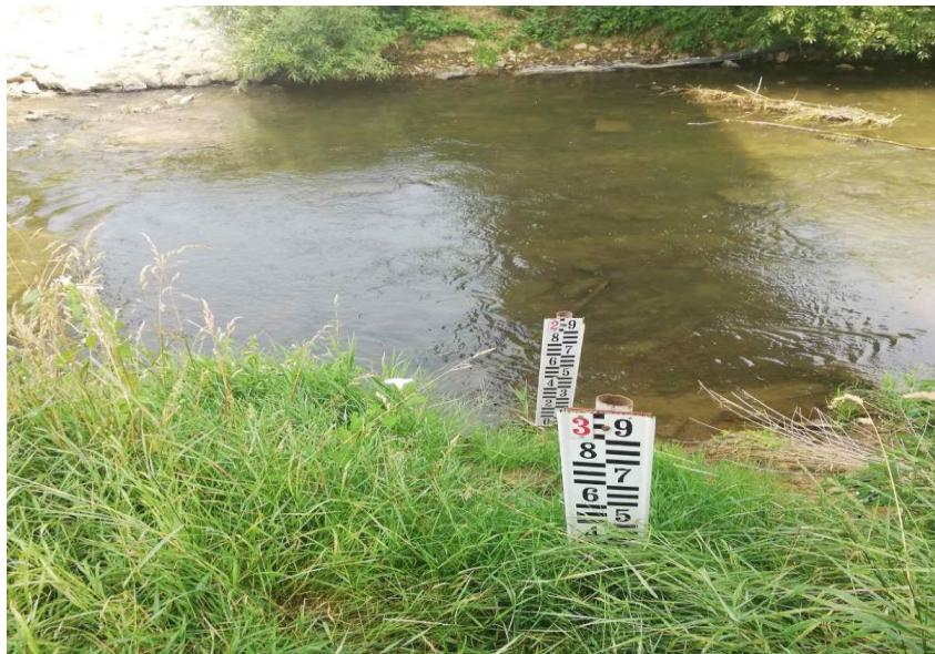
Slika 5. Pojedinačne vodokazne letve u rasponu od 0 do 300 cm na HP Tuhovec
