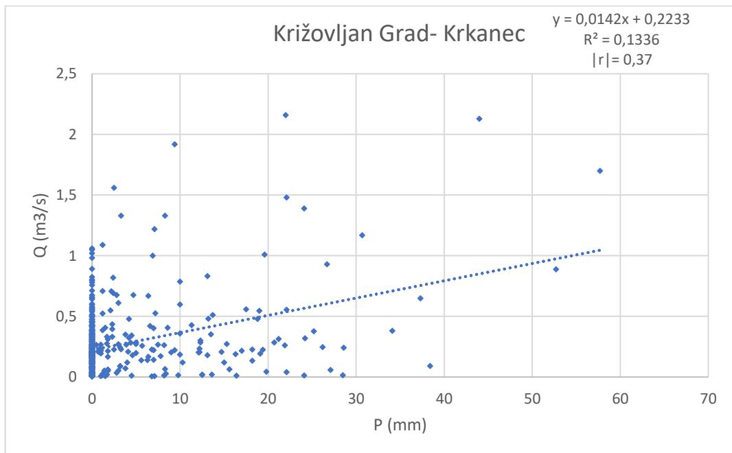
Slika 27. Korelacijska analiza oborina i protoka s kišomjerne postaje Križovljjan Grad i hidrološke postaje Krkanec u razdoblju od 2016. do 2019.
