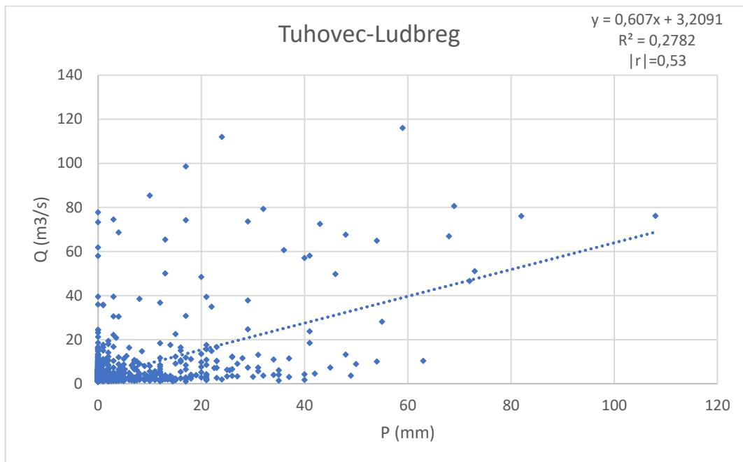
Slika 24. Korelacijska analiza oborina i protoka vlastitih mjerena u Tuhovcu i hidrološkoj postaji Ludbreg u razdoblju od 2013. do 2019.
