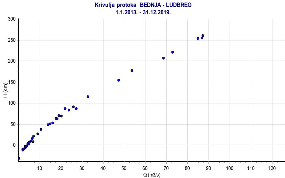
Slika 4. Primjer konsumpcijske (protočne) krivulje za HP Bednja-Ludbreg
