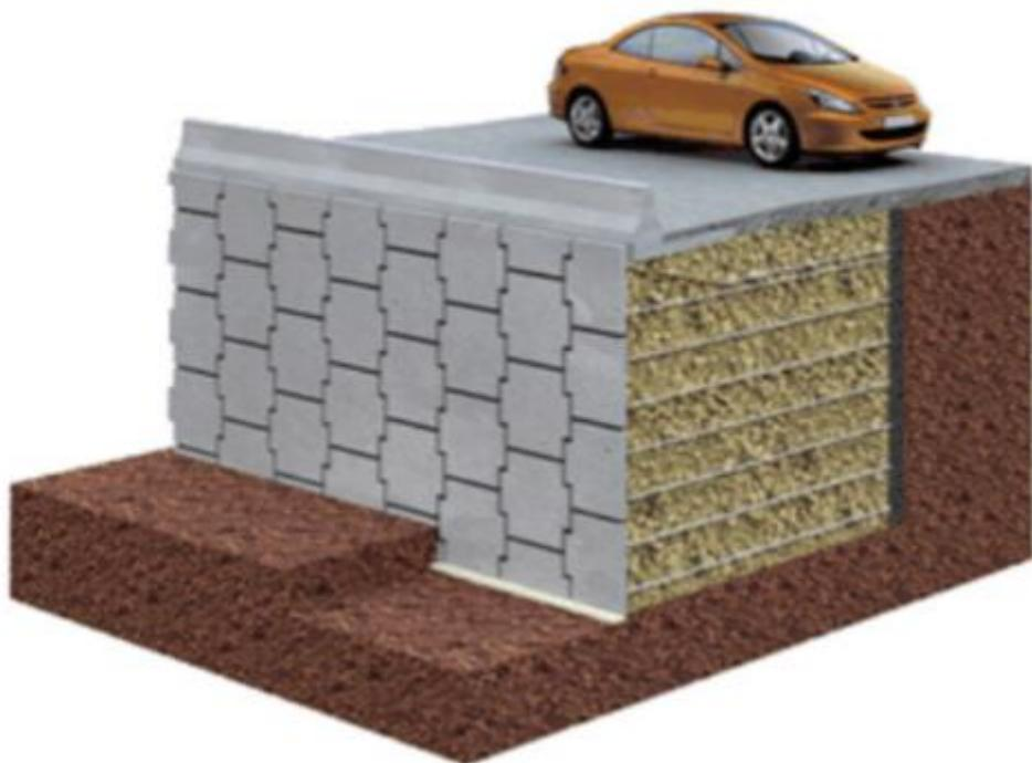
Slika 4. Potporni zid od armiranog tla (Terre-armee, 2021)
