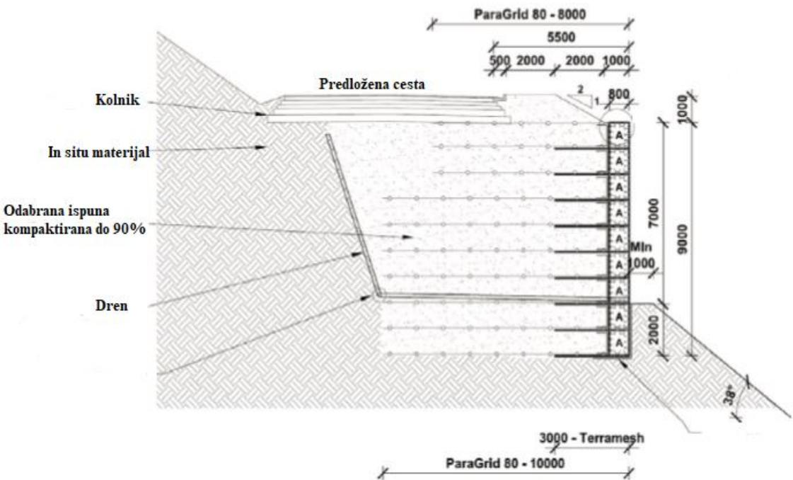
Slika 14. Poprečni presjek konstrukcije od armiranog tla (Maccaferri, 2015.)
