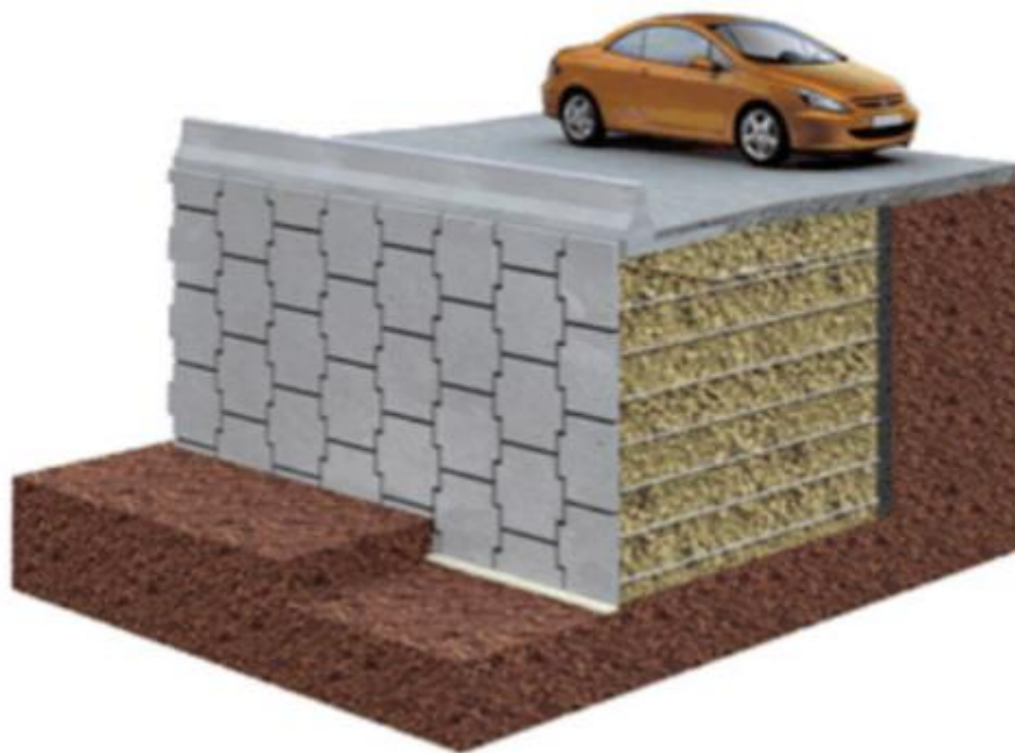
Slika 4. Potporni zid od armiranog tla (Terre-armee, 2021)
