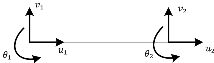
Slika 13 Stupnjevi slobode gibanja za 2 D gredu
