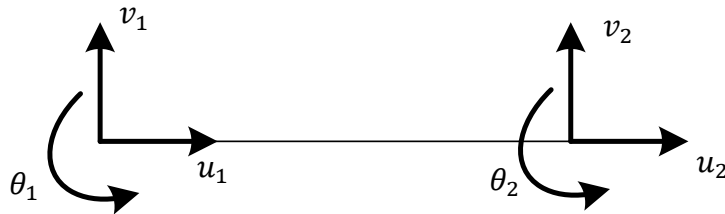
Slika 13 Stupnjevi slobode gibanja za 2 D gredu
