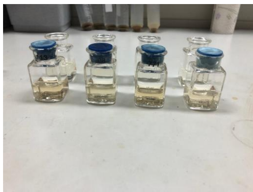
Slika 13. Pripremljeni uzorci za određivanje \text{NO}_3^-
