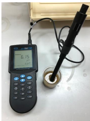
Slika 10. Mjerenje pH eluata tla sa pH metrom HACH Sension 156
