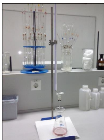
Slika 19. Titracija eluata tla s NaOH [12]
