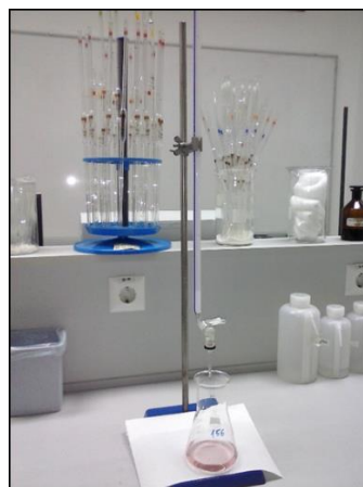
Slika 19. Titracija eluata tla s NaOH [12]
