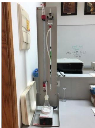
Slika 18. Mjerenje karbonata Scheiblerovim kalcimetrom
