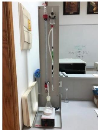
**Slika 18.** Mjerenje karbonata Scheiblerovim kalcimetrom
