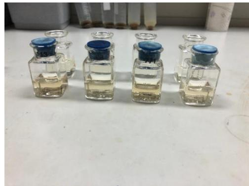
**Slika 13.**Pripremljeni uzorci za određivanje  $\text{NO}_3^-$
