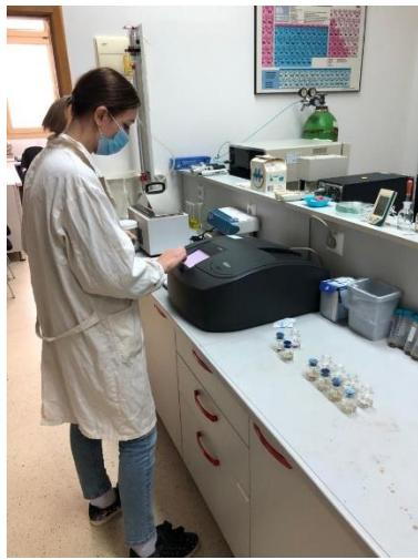
**Slika 12.** Određivanje humusa na spektrofotometru HACH DR 5000
