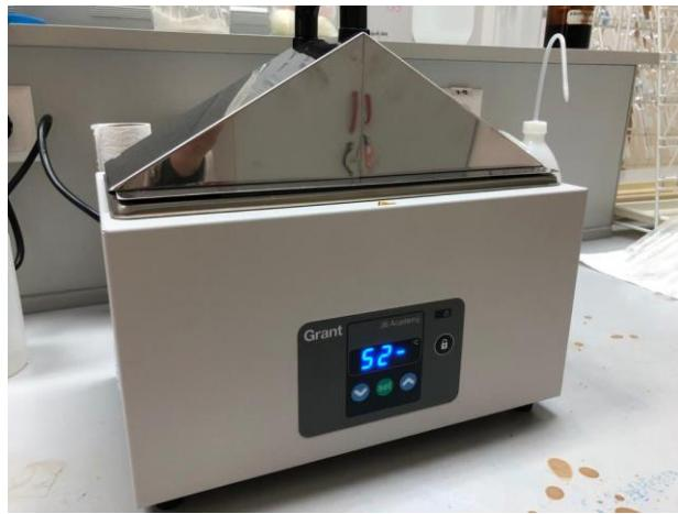
**Slika 16.** Zagrijavanje uzorka u vodenoj kupelji
