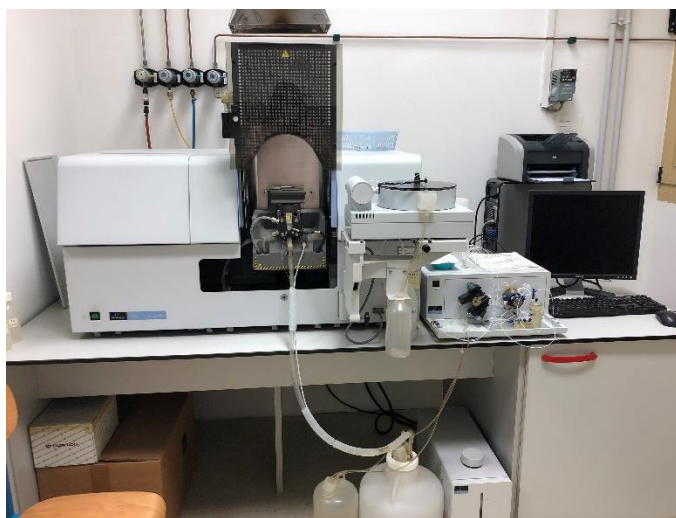
Slika 17. Određivanje kalija na spektrometru Perkin Elmer Analyst 800
