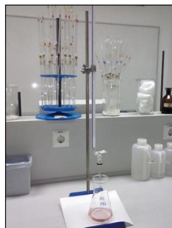
**Slika 19.** Titracija eluata tla s NaOH [12]
