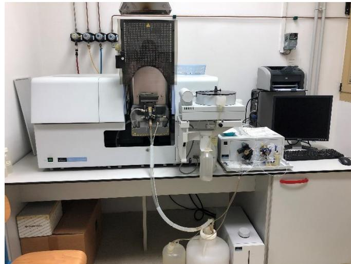
**Slika 17.** Određivanje kalija na spektrometru Perkin Elmer Analyst 800
