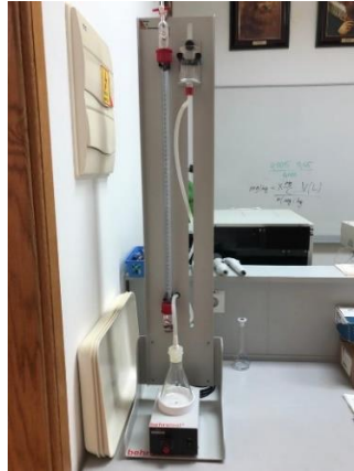
Slika 18. Mjerenje karbonata Scheiblerovim kalcimetrom
