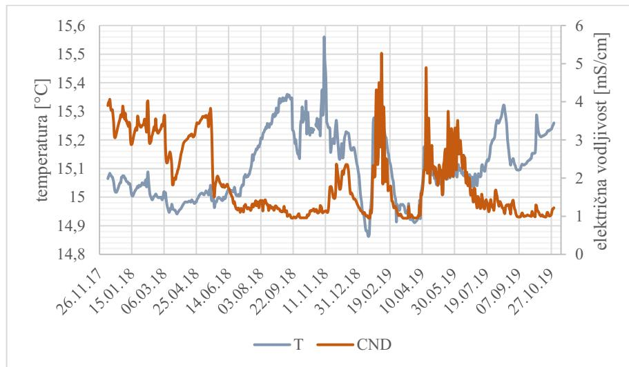
**Slika 20. Grafički prikaz električne vodljivosti i temperature na vodocrpilištu Boljkovac**
