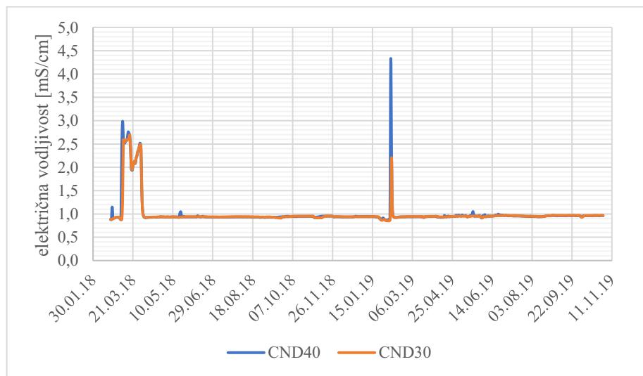
**Slika 34. Grafički prikaz odnosa električne vodljivosti na dubinama od 30 i 40 metara u piezometarskoj bušotini BOLJ-1**
