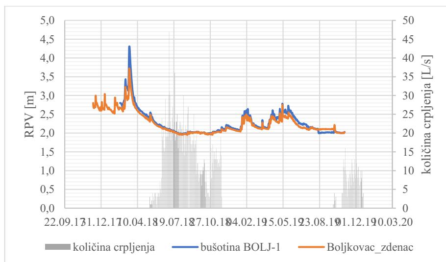
**Slika 32. Grafički prikaz odnosa količina crpljenja i razina podzemnih voda na vodocrpilištu Boljkovac i u piezometarskoj bušotini BOLJ-1**
