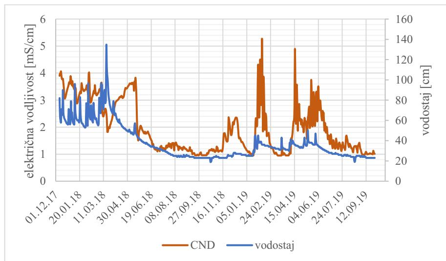
**Slika 22. Grafički prikaz odnosa električne vodljivosti na vodocrpilištu Boljkovac i vodostaja na hidrološkoj postoji Boljkovac na vodotoku Miljašić Jaruga**
