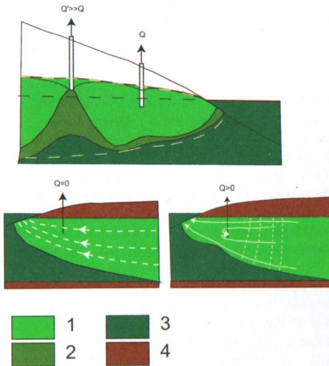
**Slika 7. Shematski prikaz konusnog podizanja slane vode zbog prekomjernog crpljenja podzemne vode u priobalnim vodonosnicima, 1 – slatka voda, 2- zaslanjena voda, 3 – slana (morska) voda, 4 – nepropusne naslage (Biondić, B. i Biondić, R., 2014)**
