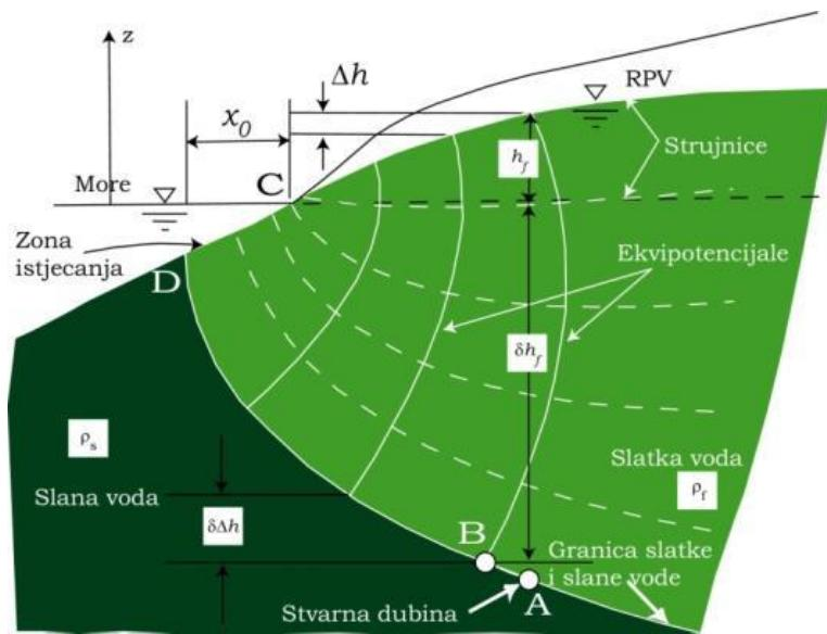
**Slika 3. Prikaz stvarnog tečenja vode u priobalnoj zoni:** A – stvarna dubina od površine do zone miješanja, B – dubina od površine do zone miješanja prema Ghyben-Herzbergovom zakonu
