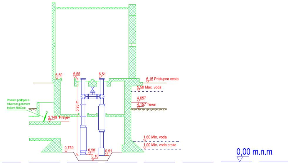
**Slika 13. Presjek vodocrpilišta Boljkovac s osnovnim tehničkim značajkama (Terzić i Lukač Reberski, 2013)**
