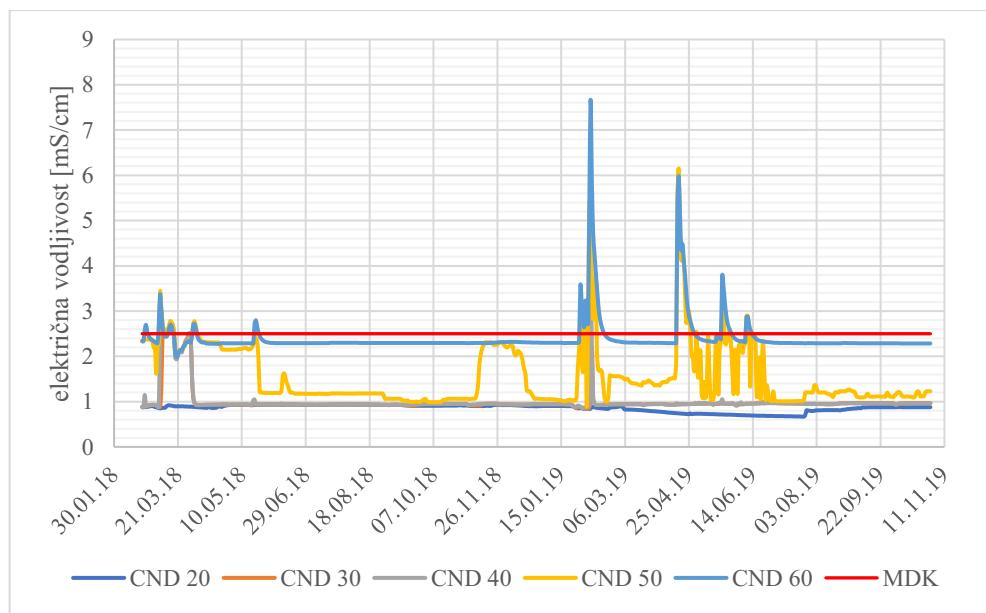
**Slika 35. Grafički prikaz promjena električne vodljivosti na različitim dubinama duž piezometarske bušotine BOLJ-1 s označenom maksimalnom dopuštenom koncentracijom**
