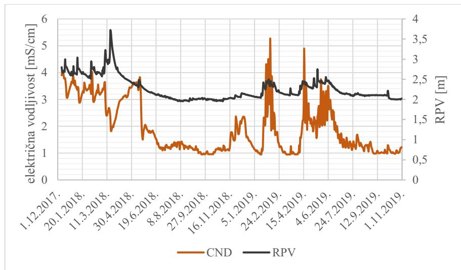
**Slika 19. Grafički prikaz odnosa razine podzemne vode i električne vodljivosti na vodocrpilištu Boljkovac**
