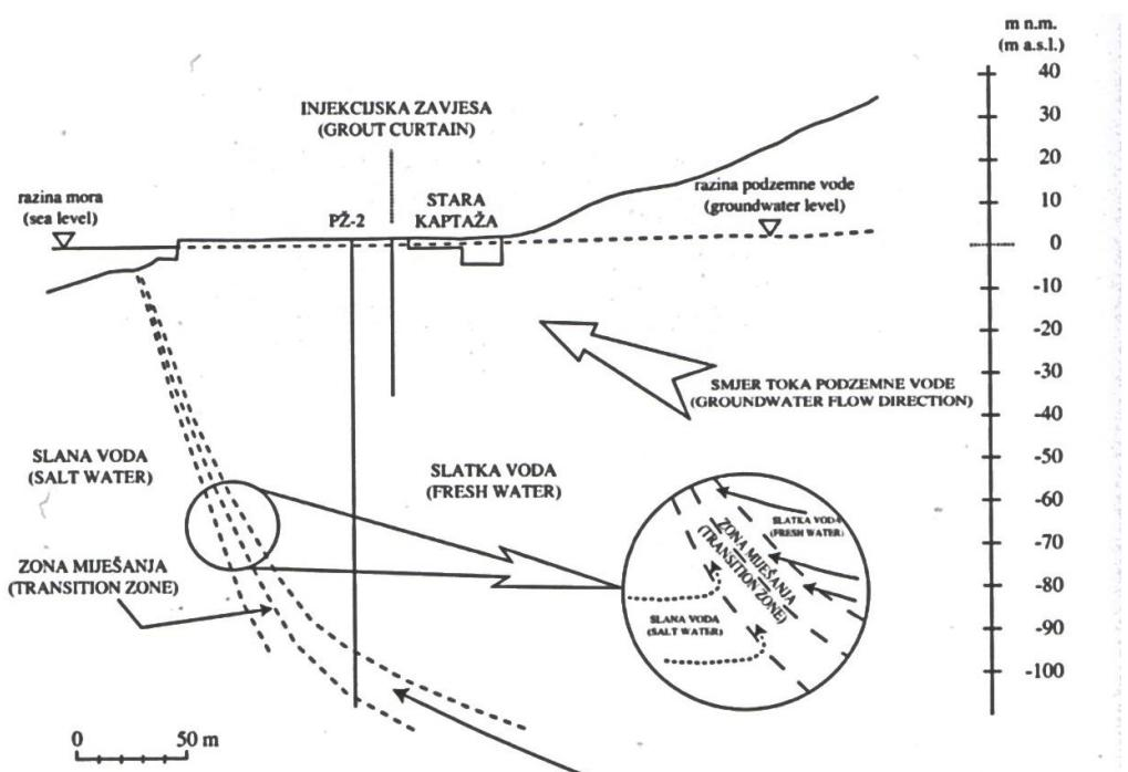
Slika 4. Shematski prikaz tečenja u priobalnom vodonosniku (Biondić, B. i Biondić R., 2014)
