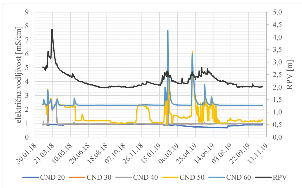
**Slika 33. Grafički prikaz promjena električne vodljivosti i razine podzemne vode na različitim dubinama duž piezometarske bušotine BOLJ-1**
